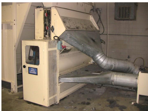
Slika 2.3: Vertikalni rahljalnik Temafa in rahljalni valj z iglasto oblogo za intenzivno rahljanje kosmičev [4]
