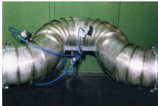
Slika 2.4: Cevovod Temafa z razpršilnimi šobami za pnevmatski transport in maščenje prediva [3]
