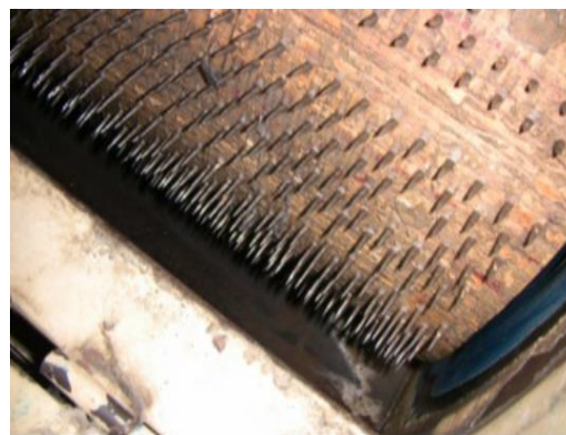
Slika 2.3: Vertikalni rahljalnik Temafa in rahljalni valj z iglasto oblogo za intenzivno rahljanje kosmičev [4]
