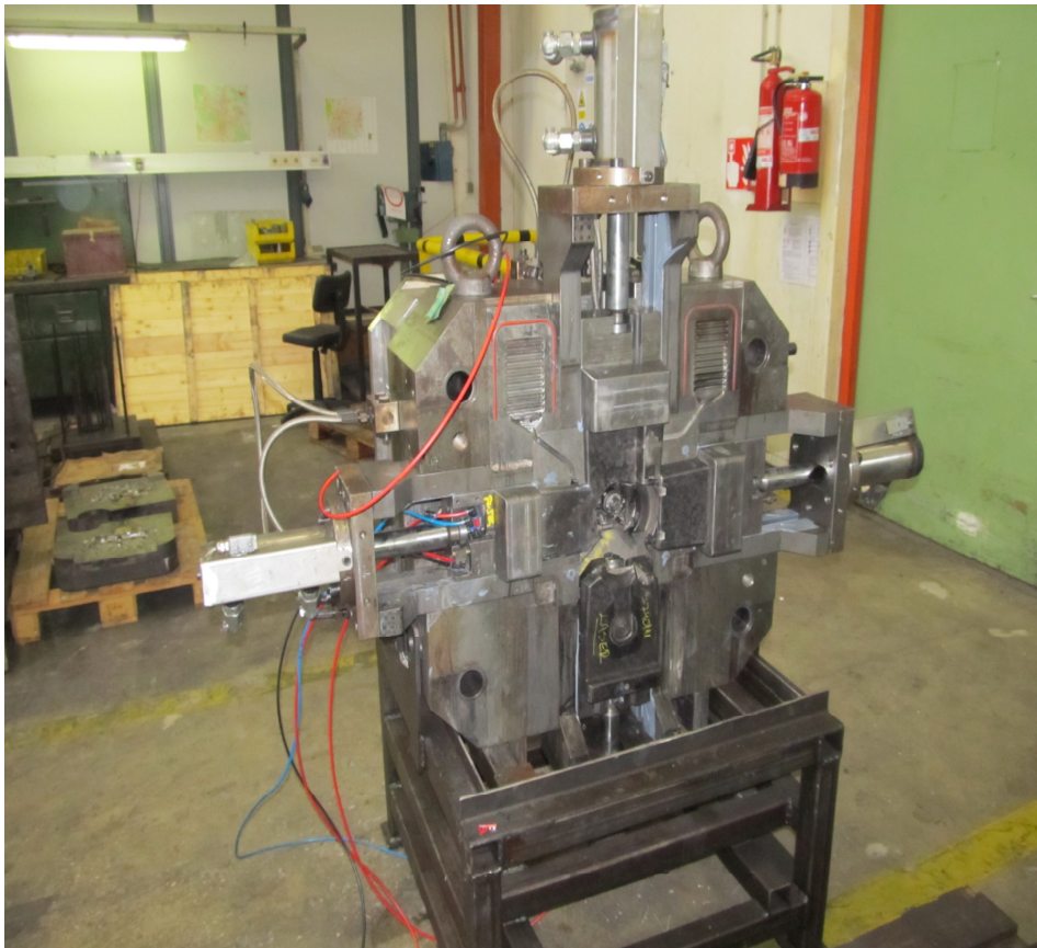
Slika 8: Polovica orodja pripravljenega na prevzem (vir: LTH Castings, 2012)
