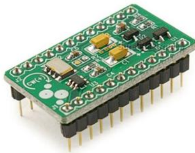
Slika 4.8: Žiroskopski senzor XV-3500CB
