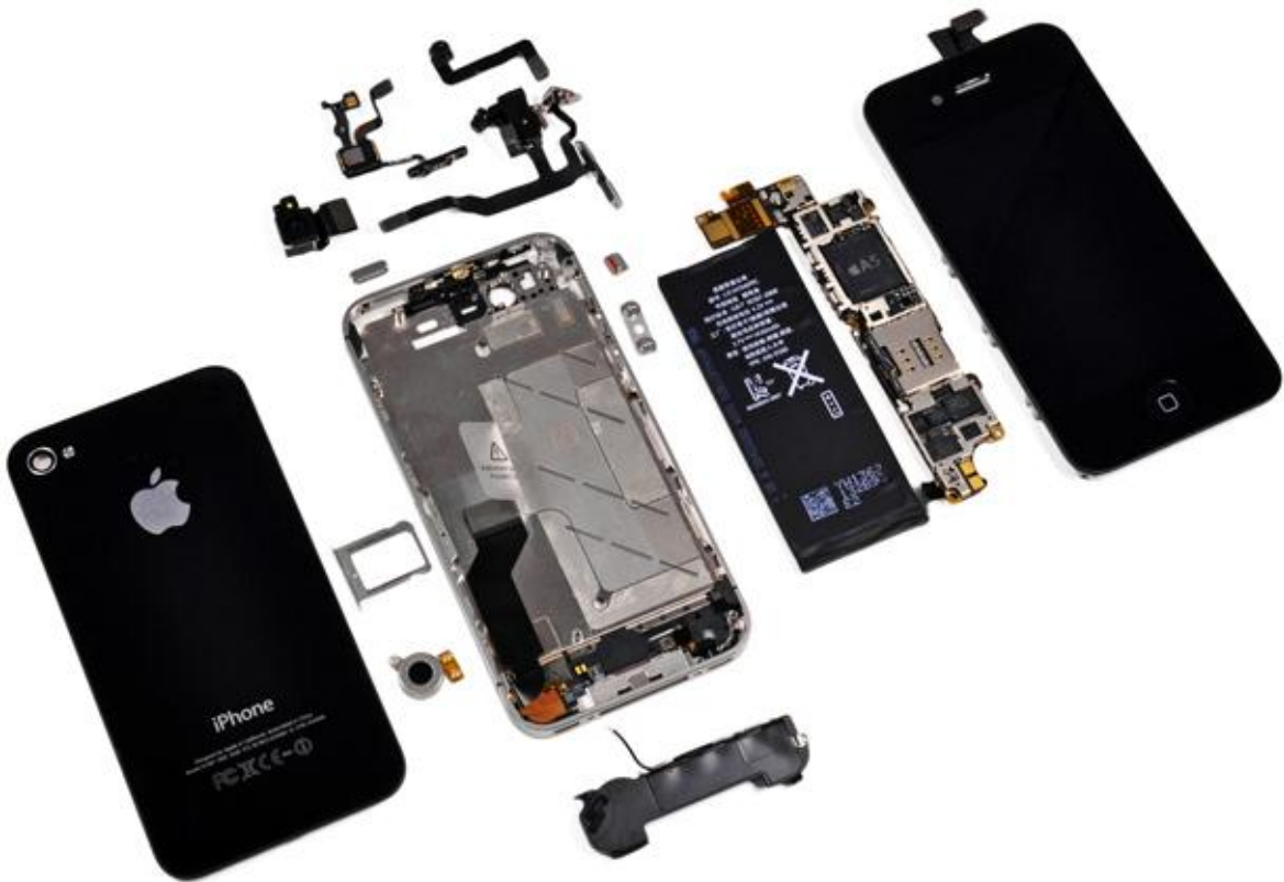
Slika 4.1 - Strojna oprema naprave iPhone 4S, iFixit, http://guide-images.ifixit.net/igi/fCQZXu4THRiQtWdv.huge
