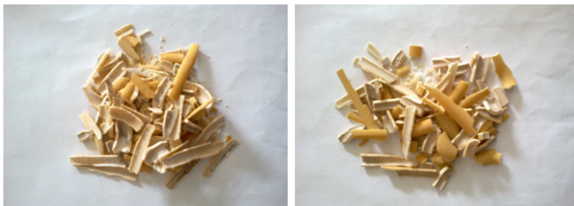
Slika 5.3: Izločen vodni kamen v primerjalni in magnetni progi.
