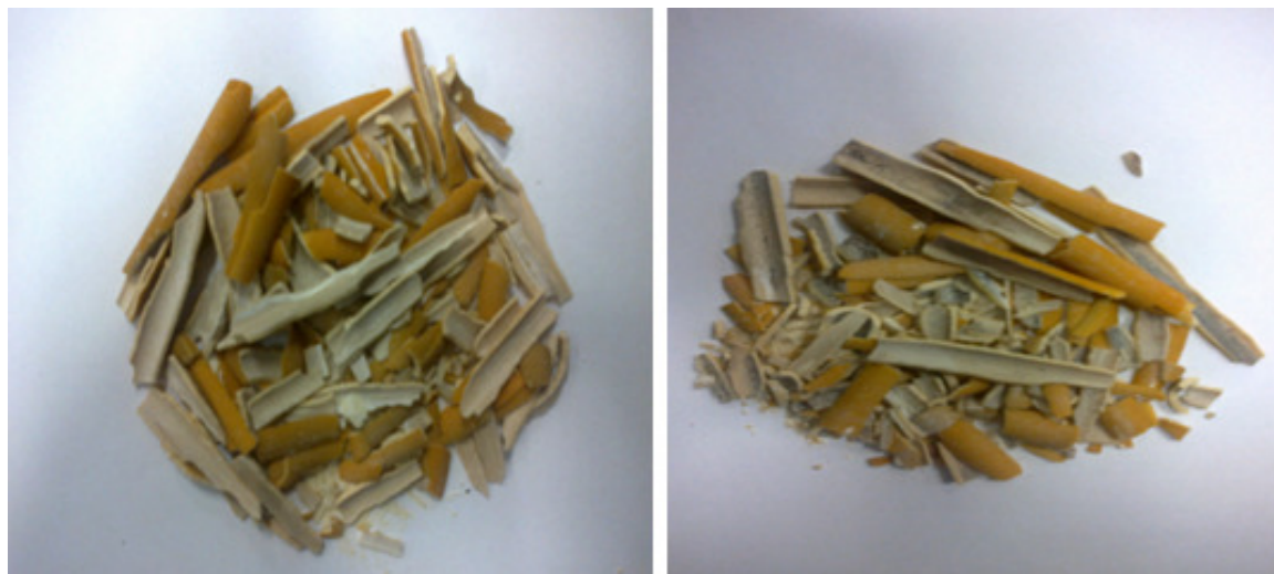
Slika 5.8: Vzorci vodnega kamna v primerjalni (levo) in magnetni (desno) progi
