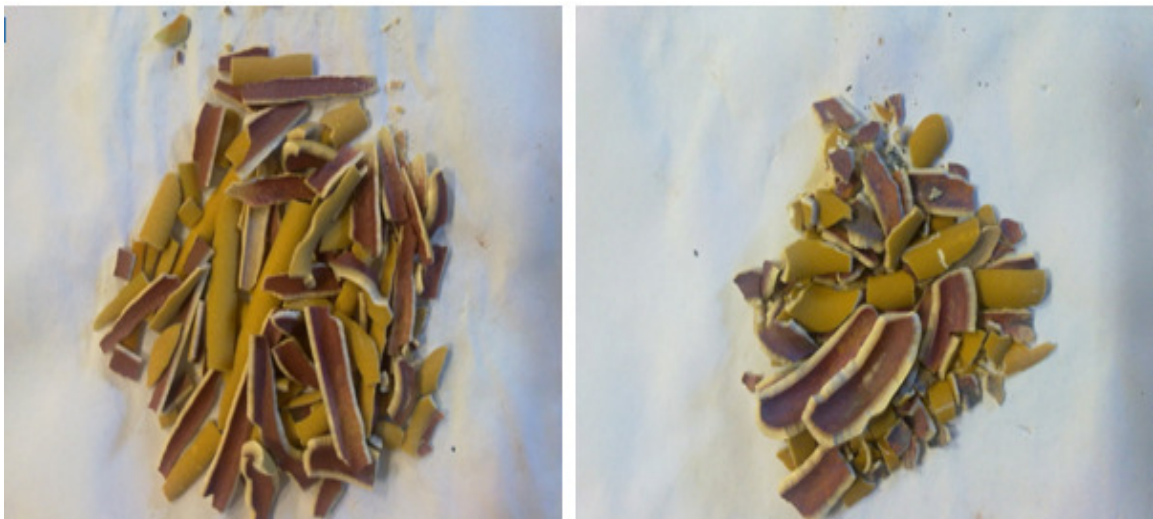
Slika 5.11: Število lusk izločenih v primerjalni progi (levo) in v magnetni progi (desno)
