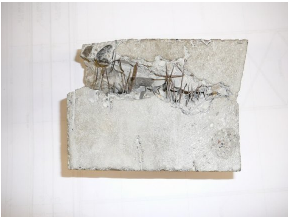
Slika 6: mikroarmirani beton z NORIK jeklenimi vlakni (vir: http://www.norik.si/prodajni-program/norik-jeklena-vlakna )
