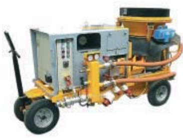
Slika 4: stroj za suho in mokro brizganje betona Aliva (vir: Stroji za brizganje betona in gradnjo predorov. Dostopno na naslovu: http://svn.sika.com/ )
