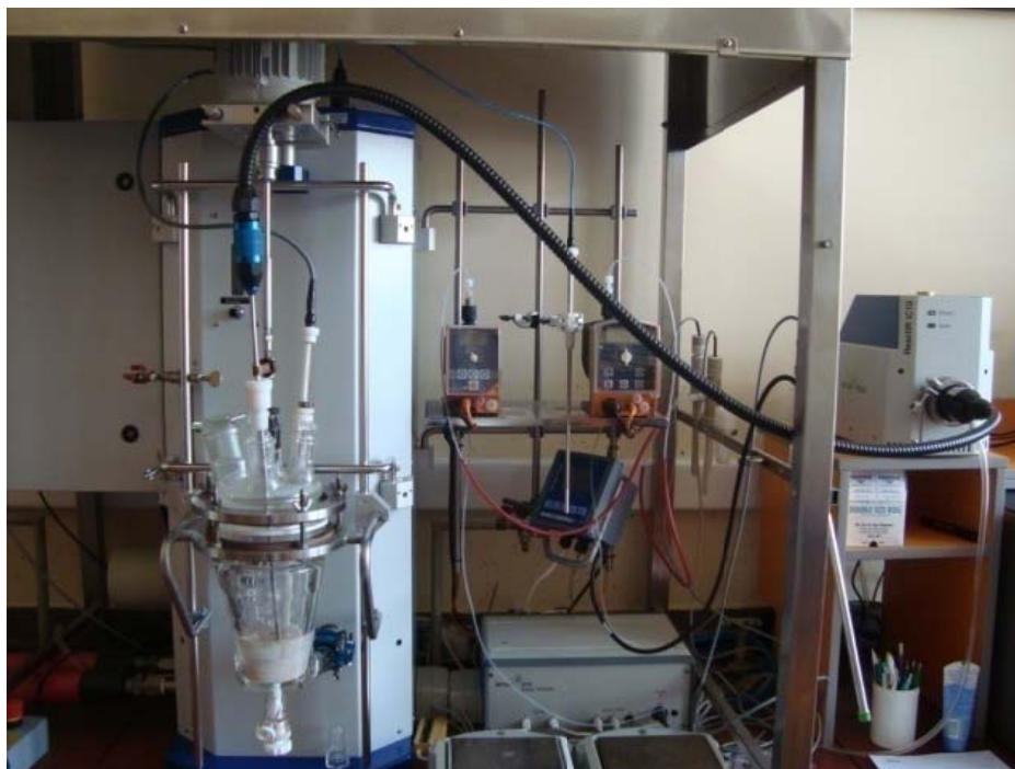
Slika 4 – 2: RC1 šaržni reaktor (levo) in ReactIR iC10 spektrometer (desno).
