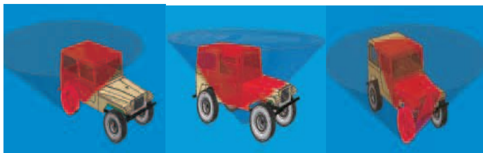
Slika 10: Primer stožca uničenja za lahko logistično vozilo
