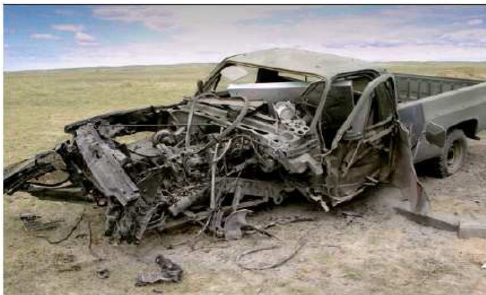
Slika 4: Učinek eksplozije 6,5 kg protitankovske mine pod tovornim vozilom
