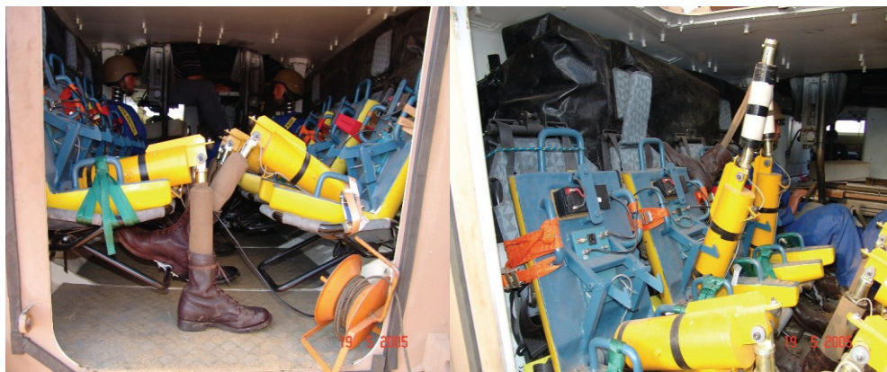
Slika 49: Pozicija testnih lutk in testne noge pred in po testu
