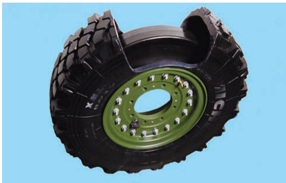
Slika 24: Runflat vložek znotraj pnevmatike
