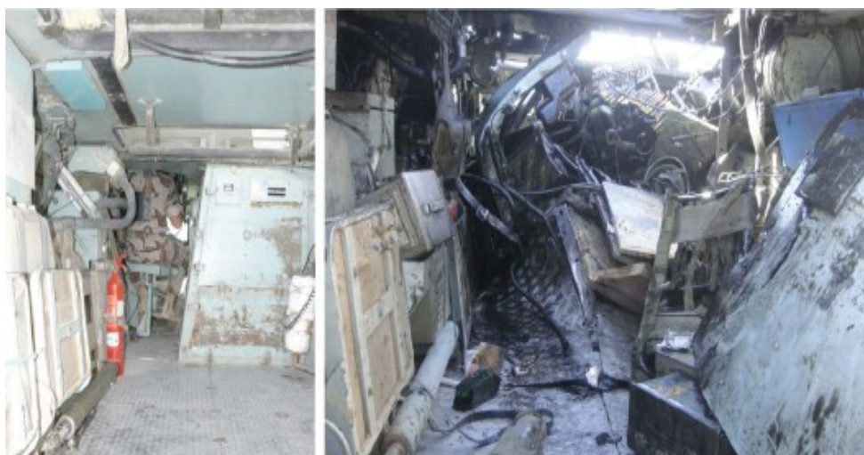
Slika 31: Slika vozila pred in po preboju školjke vozila
