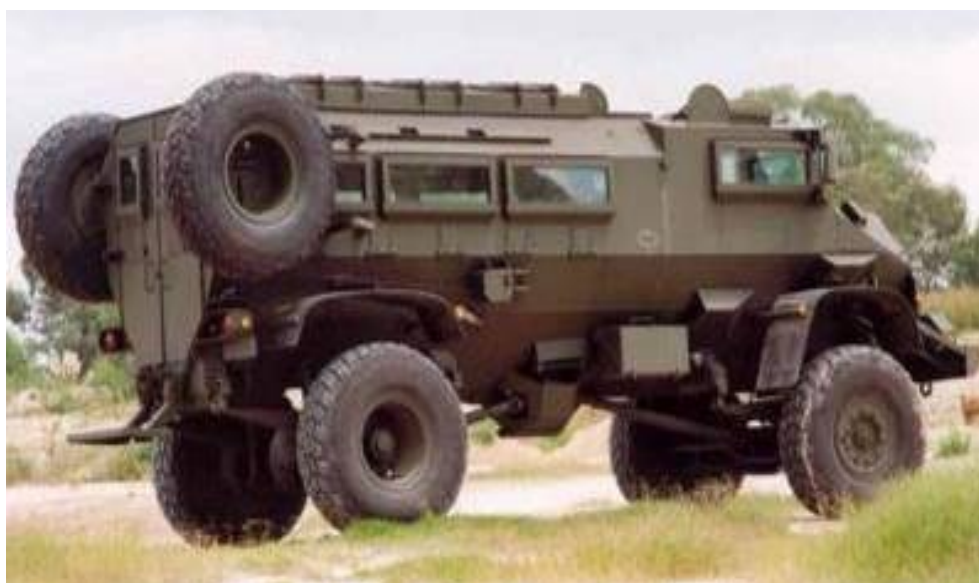
Slika 19: Primer vozila s trikotnim dnom
