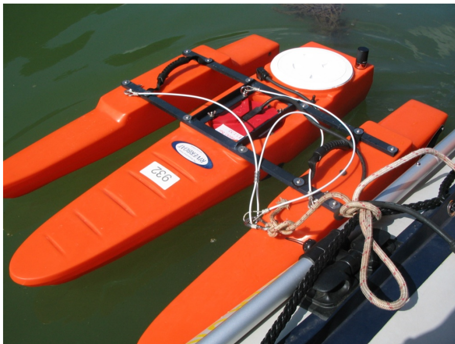
Slika 1: Akustični Dopplerjev merilnik pretokov
