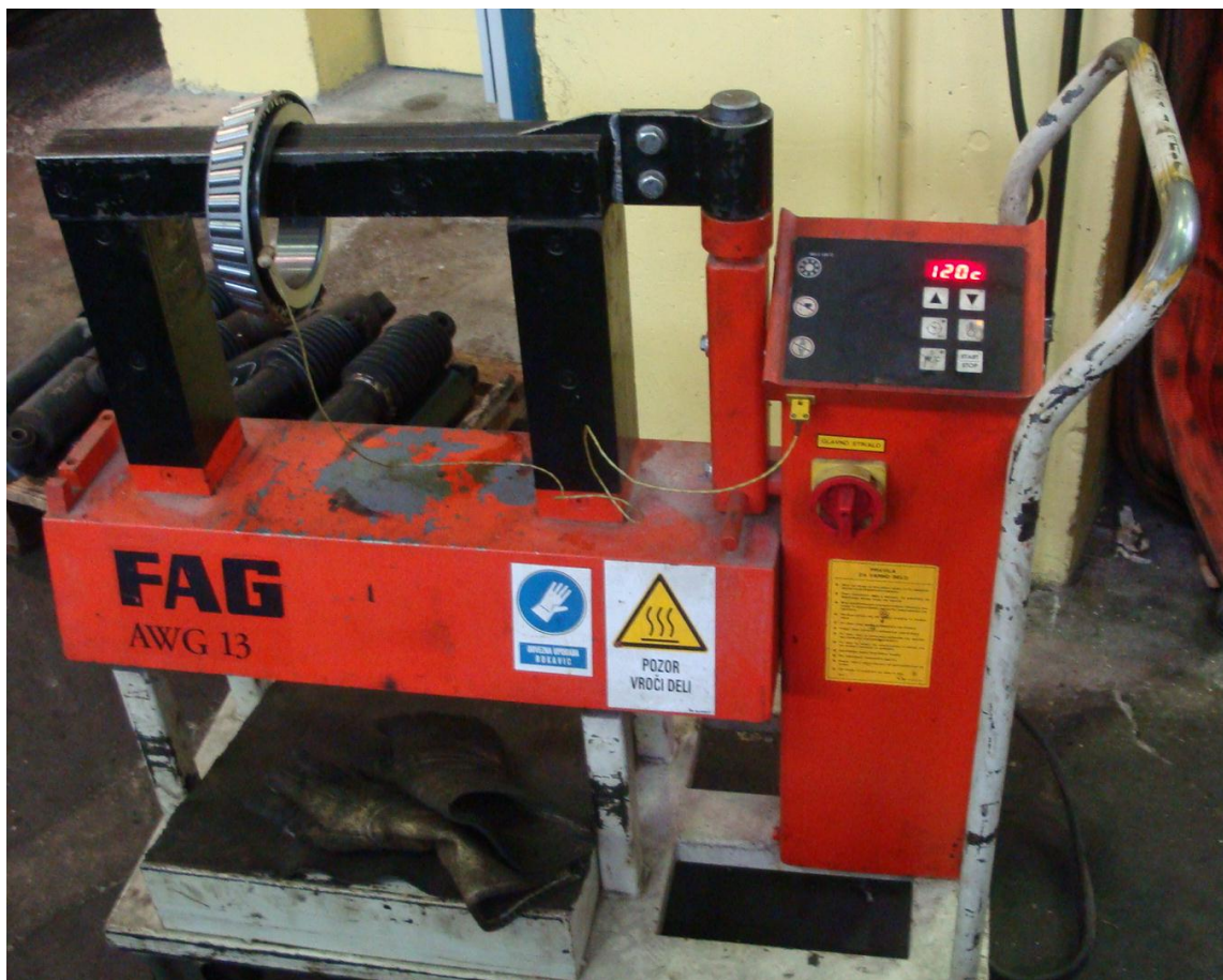
Slika 3.6: Segrevanje kotalnega ležaja
