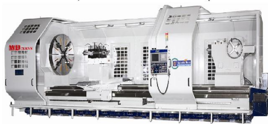
Slika 4.2: CNC stružnica WD TEHNIK CST -50 kot možna zamenjava za brusilni stroj COPPARO in stružnico Potisje PA 1000R
