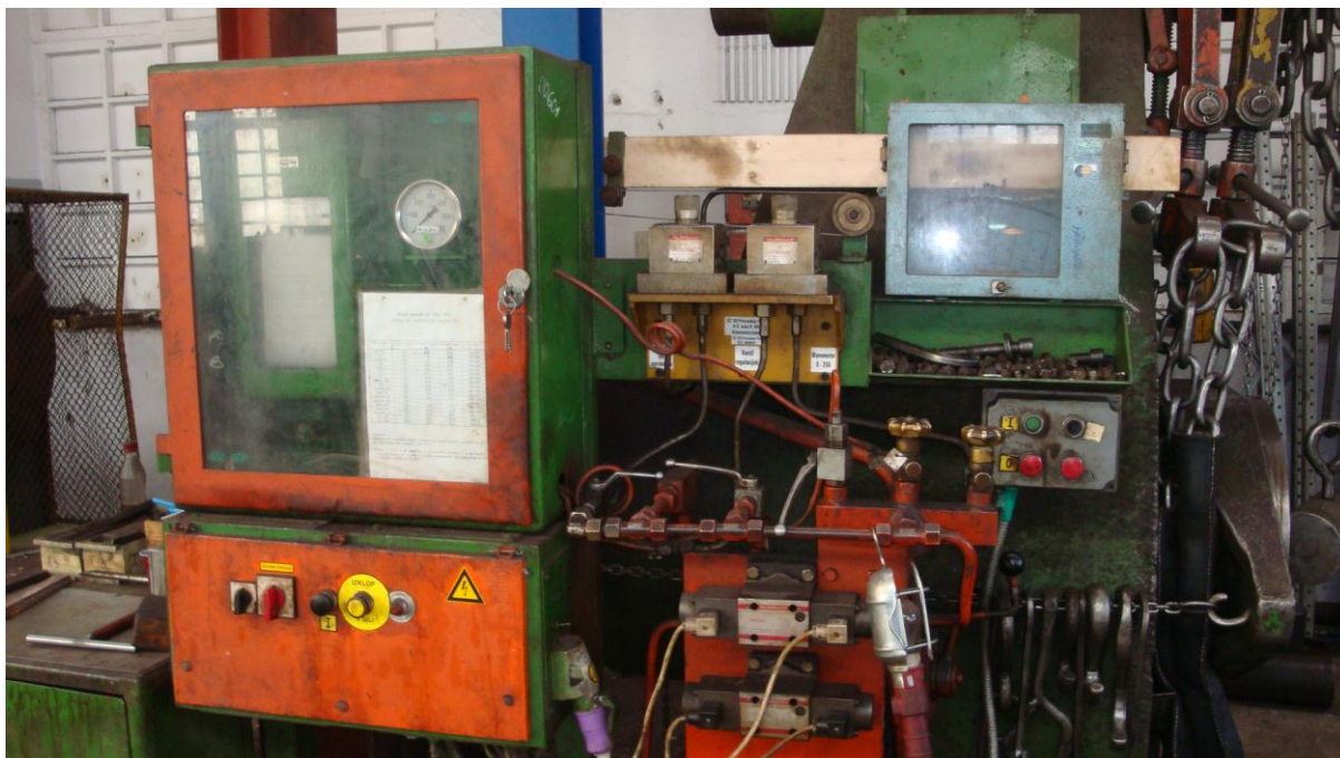
Slika 3.8: Hidravlična preša s kalibrirnim, pisalnim tlakomernim instrumentom
