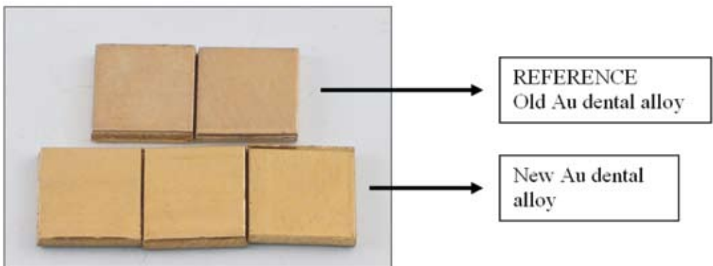
Figure 3. Old and new Au-Pt-Zn alloy specimens for testing optical properties Slika 3. Vzorci iz stare in nove Au-Pt-Zn zlitine za testiranje optičnih lastnosti
