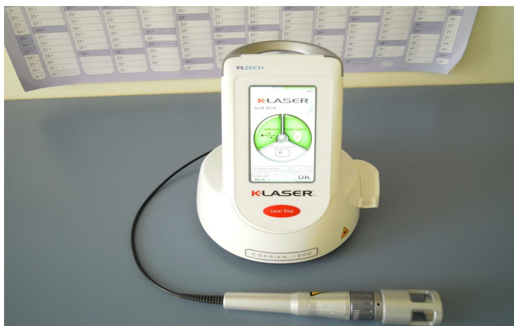
Slika 1: Polprevodniški LED laser serije K-1200
