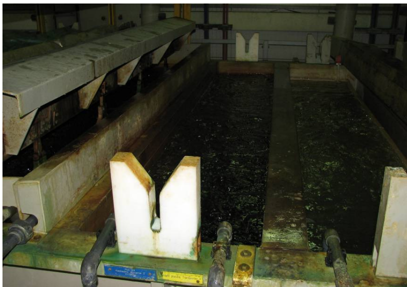
Slika 4: Izpiralna kad z vodo
