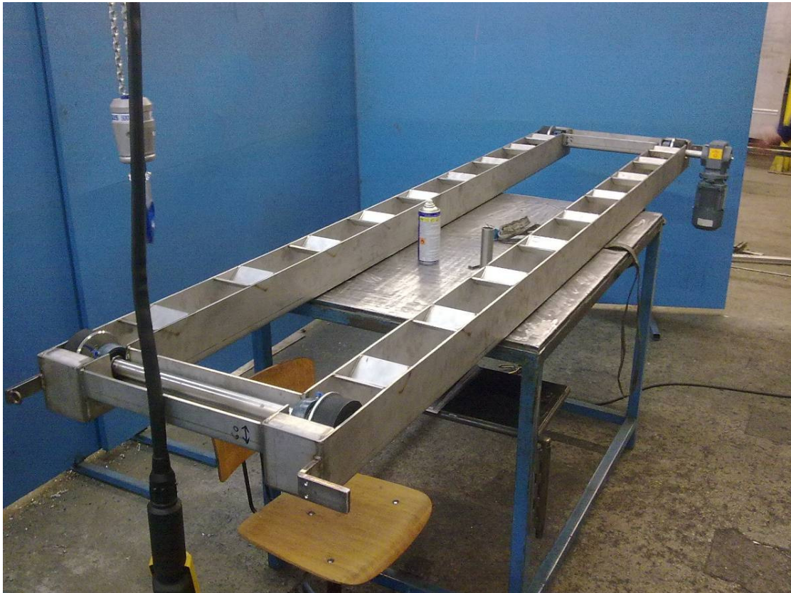
Slika 29: Sestavljen transportni voziček
