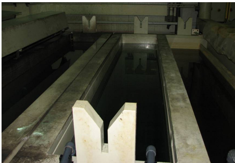
Slika 5: Jedkanje v 10 – 20 % kislini H_2SO_4
