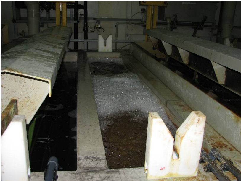
Slika 3: Biološko in katodno razmaščevanje
