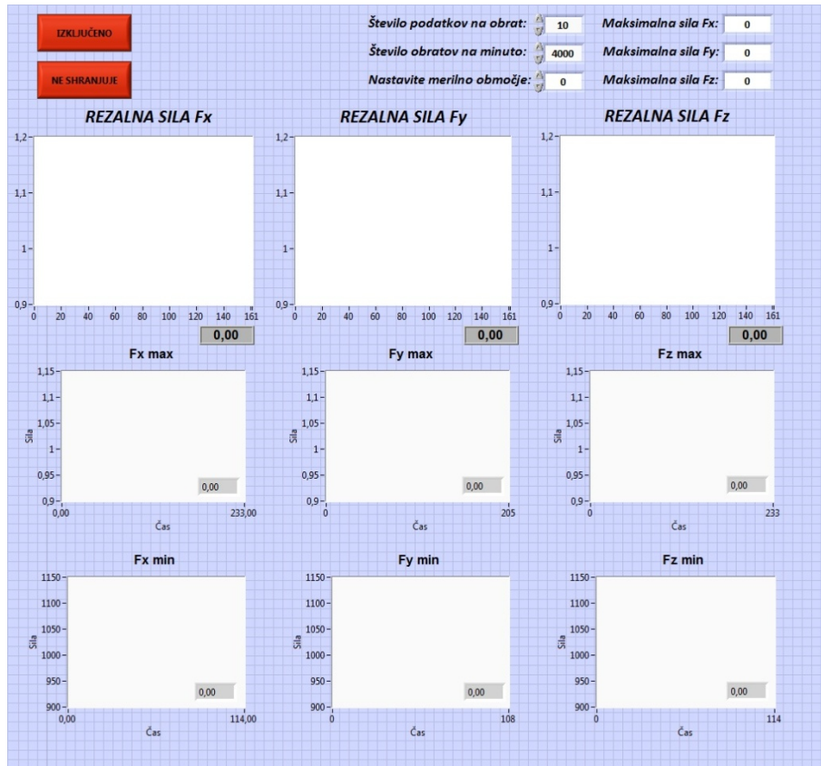
Slika 24: Program za zajemanje in prikazovanje sil – čelna plošča
