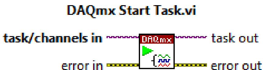
Slika 27: Blokovna shema DAQmx Start Task
