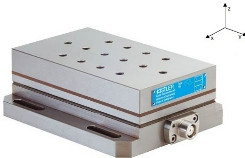
Slika 4: Smeri zajemanja rezalnih sil
