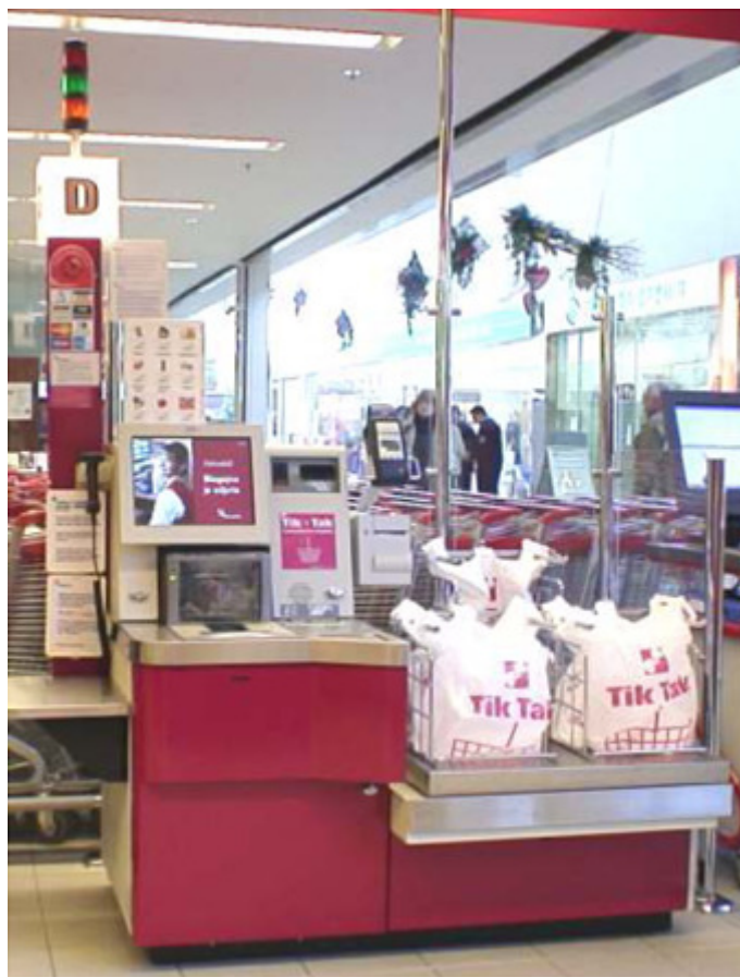
Slika 5. Samopostrežna blagajna Tik-Tak (model Mini Lane).
