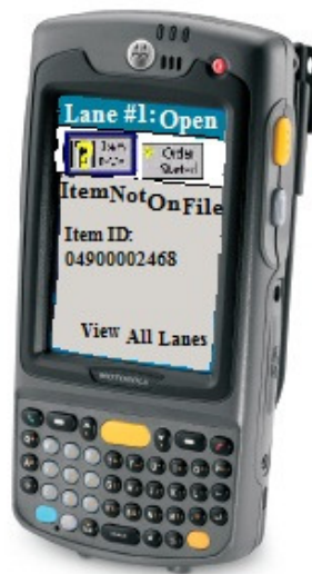
Slika 14. Terminal Motorola MC70 EDA s tipkovnico in prikazanim primerom obvestila.
