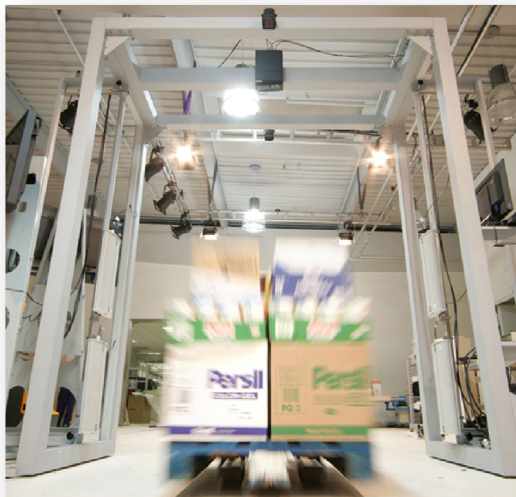
Slika 7: Čitalec fiksne izvedbe - vhodna RFID vrata
