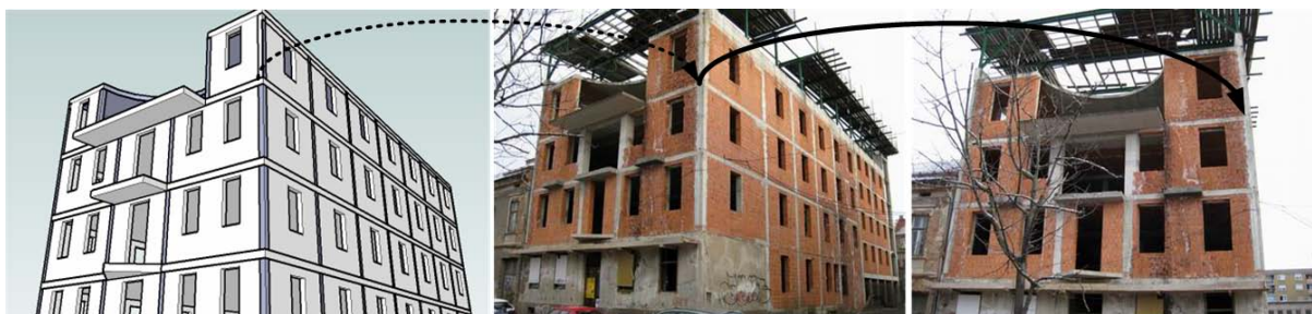
Slika 1.1: Korespondenca med 3D referenčnim modelom in sliko prve kamere (prekinjena črta). Korespondenca med točkama iz obeh slik je bila izračunana z metodo ASIFT-SH (polna črta).
