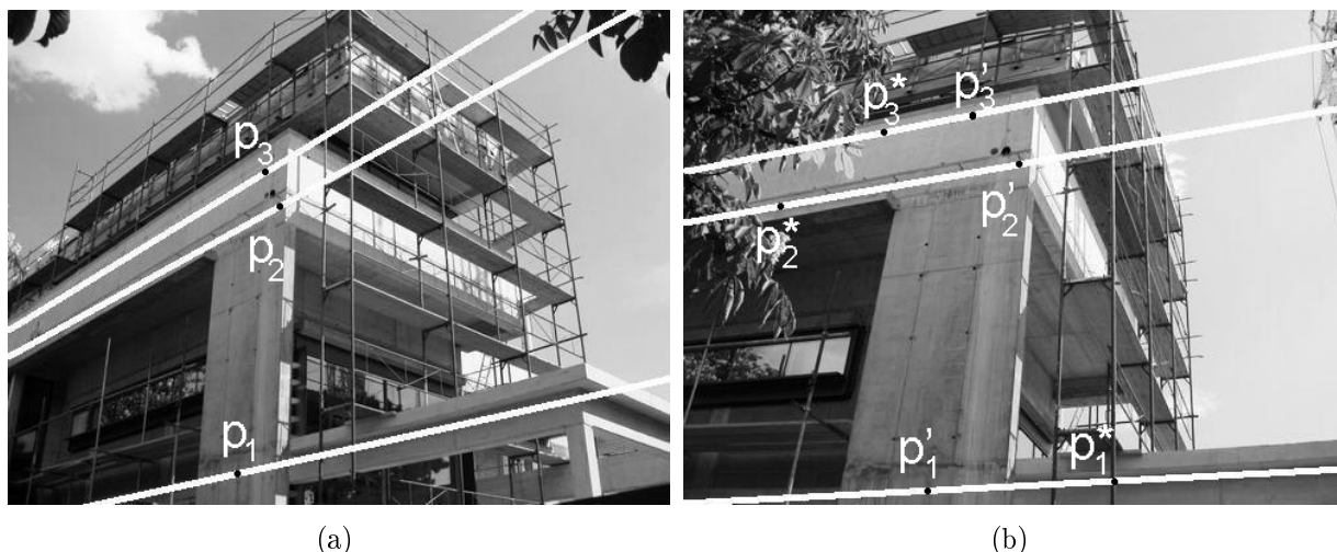
Slika 7.7: Korespondenčna epipremica (polna črta) za par slik iz meritve "Meritev 4": (a) poljubno izbrane točke p_i in (b) njihove dejanske korespondenčne točke p'_i (Zlati standard) na epipremici in z metodo EPI izračunane korespondenčne točke p_i^* .
