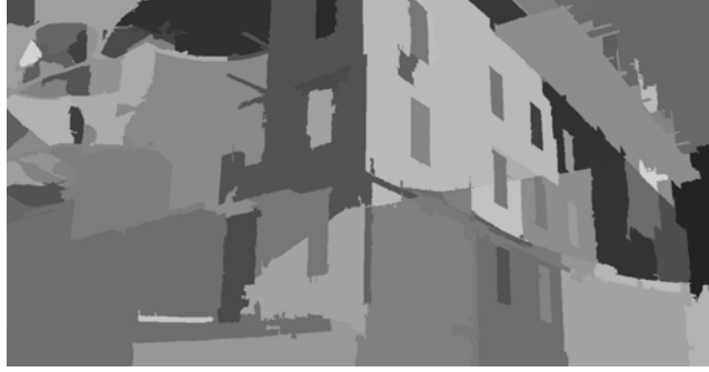
Slika 4.2: Rezultat segmentacijske metode, ki temelji na grafu za sliko prve kamere (glej zgornjo sliko 4.1). Izbrana segmentacijska metoda zahteva tri parametre: \gamma , K in min . Parametri so bili določeni empirično in so bili nespremenjeni za vse eksperimente ( \gamma = 1 , K = 1000 , min = 2000 ).
