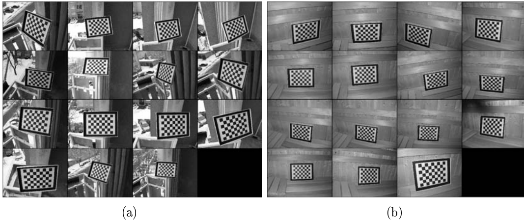
Slika 6.10: Kalibracijski vzorec "šahovnica", posnet z eno kamero iz 15 različnih pogledov pri temperaturi a) 0^{\circ}\text{C} in b) 50^{\circ}\text{C} . Velikost slik je 1600 \times 1280 slikovnih elementov. Za doseganje boljše natančnosti je bilo izvedenih pet meritev pri vsaki temperaturi.
