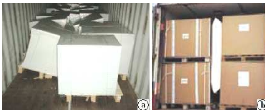
Slika 91: Zalaganje vmesnih praznin z napihljivimi vrečami
