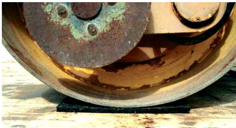
Slika 119: Uporaba tornih podlog pri prevozu valjarja
