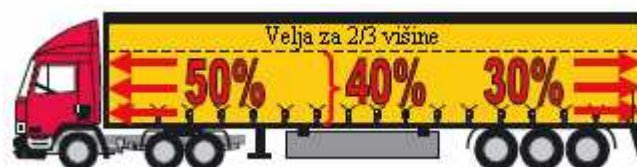
Slika 49: Konstrukcijske zahteve za nadgradnje po standardu DIN EN 12642 (Code XL)
