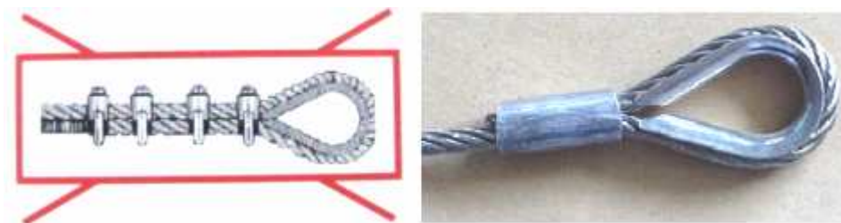
Slika 88: Nedovoljena ter ustrezna izvedba zank pri jeklenih vrveh za pritrjevanje
