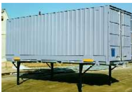
Slika 52: Zaprt menjalni keson v obliki kontejnerja
