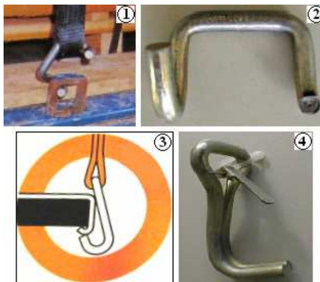
Slika 77: Vzroki in posledice za poškodbe pritrilnih mest
