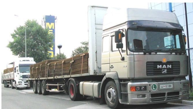
Slika 122: Nezdostno pritrjene armaturne mreže
