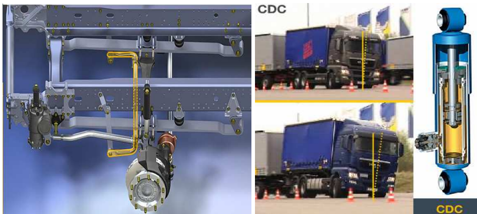
Slika 8: Deli podvozja tovornih vozil ki zmanjšujejo vzdolžno in prečno nagibanje vozila
