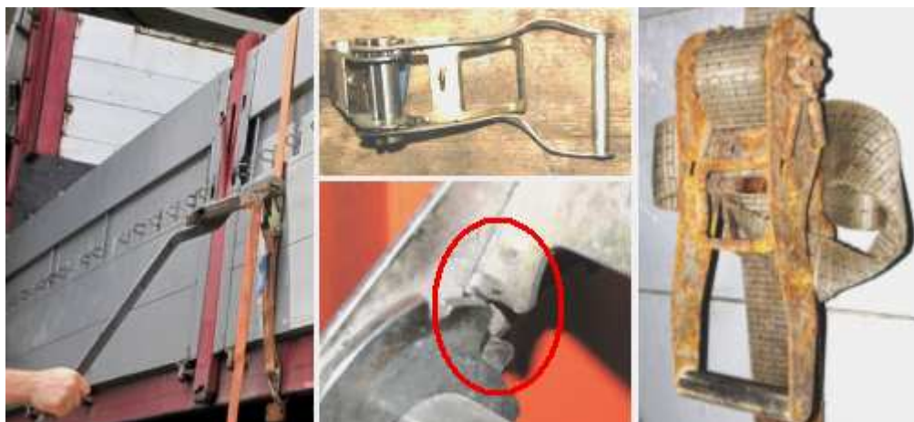
Slika 76: Nedovoljeni pripomočki, deformacije raglje ter korozija na raglji
