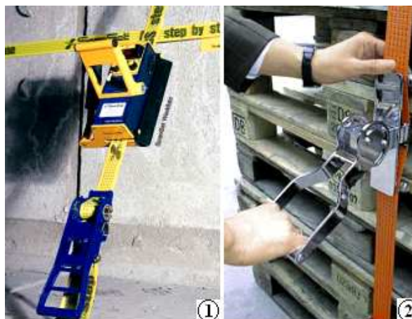
Slika 72: Merilni inštrumenti za nadzor natezne sile v pasovih za pritrjevanje
