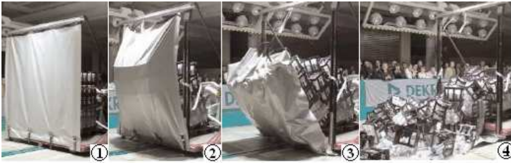
Slika 45: Preizkus vzdržljivosti ponjave pri nadgradnji z bočnimi zavesami
