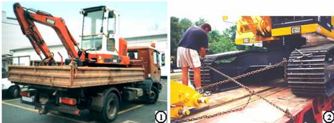
Slika 116: Nepravilno zavarovanje delovnih strojev
