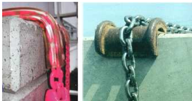
Slika 82: Zaščita robov s kotnimi ščitniki za verige
