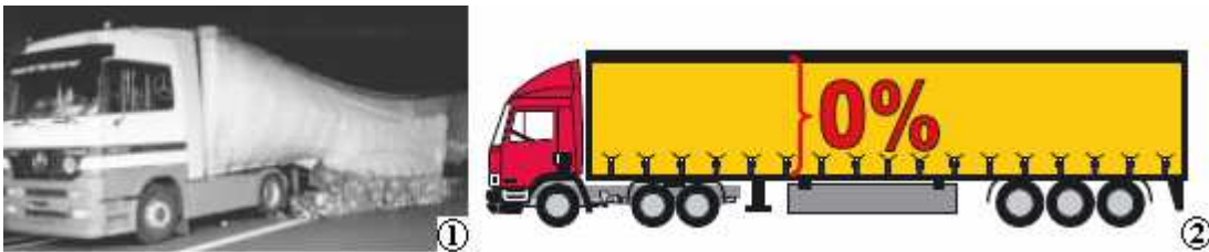
Slika 46: Nedefinirane zahteve in posledice pri nadgradnjah s ponjavo v obliki zaves
