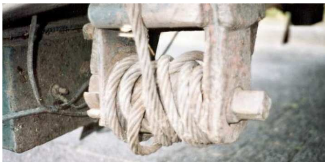
Slika 85: Neenakomerna ovitost jeklene vrvi na bobnu vitla z zaskočnim mehaizmom
