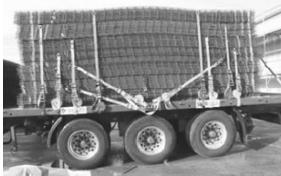
Slika 123: Pritrjevanje armaturnih mrež zgolj z uporabo pasov za pritrjevanje
