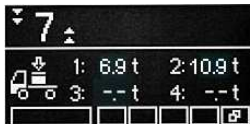
Slika 39: Prikaz osnih obremenitev na armaturni plošči tovornega vozila
