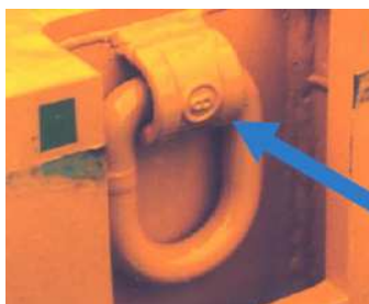
Slika 60: Oznaka dvižnega mesta, ki se ga za potrebe zavarovanja tovora sme obremeniti z dvojno nazivno silo
