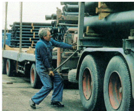
Slika 90: Nevarnost povratnega udarca drogu pri popuščanju jeklenih vrvi
