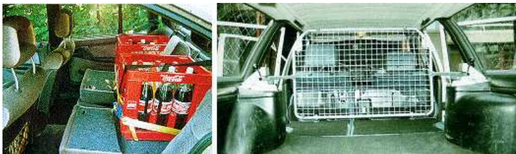
Slika 126: Načini ustreznega zavarovanja tovora v osebnih vozilih
