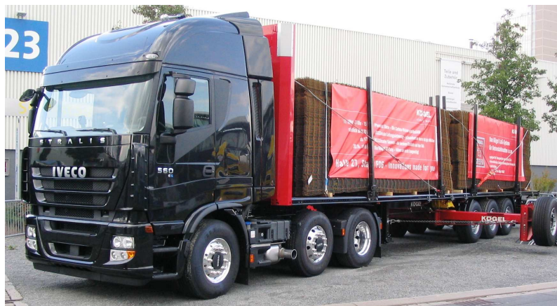
Slika 125: Prevoz armaturnih mrež z uporabo posebnih namenskih polprikolic.
