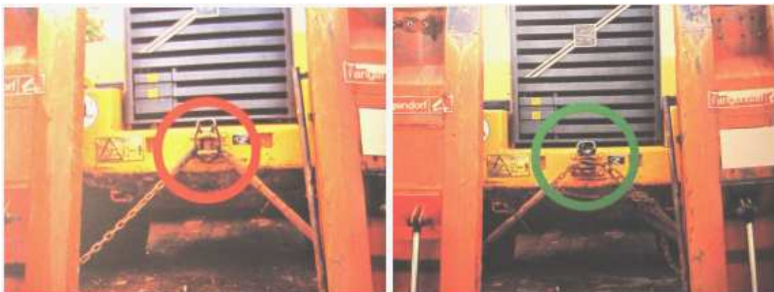
Slika 117: Neustrezna in ustrezna uporaba mest za pritrdjevanje na delovnih strojih
