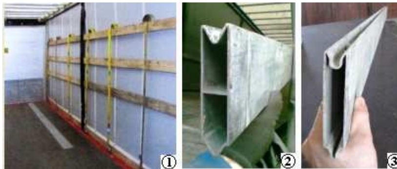
Slika 48: Bočne letve pri klasičnih in nadgradnjah in pri nadgradnjah z zavesami
