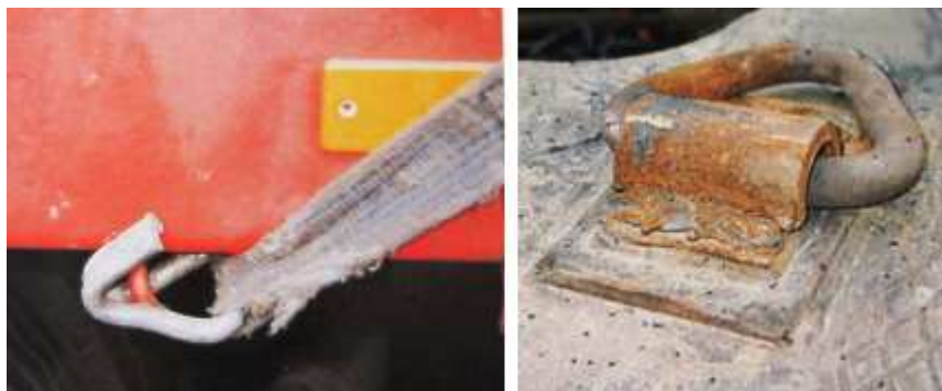
Slika 57: Neprimerno in nestrokovno nameščeno mesto za pritrdjevanje
