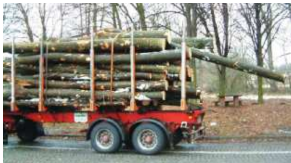
Slika 100: Premik debla v vzdolžni – vzvratni smeri
