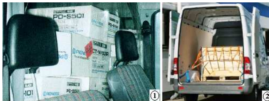
Slika 127: Praktični primer neustreznega in ustreznega zavarovanja tovora v kombiniranih vozilih.
