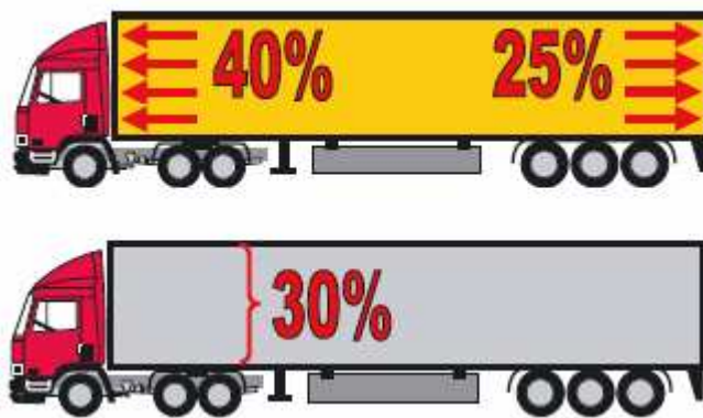
Slika 43: Zahteve za konstrukcijo nadgradenj po standardu DIN EN 12642
