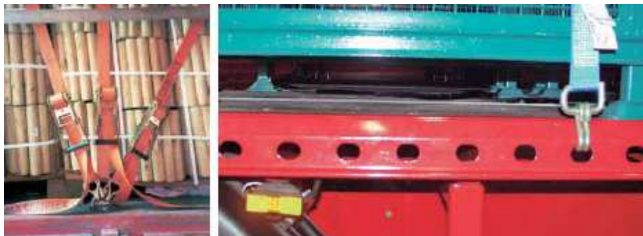
Slika 59: Težava z pomanjkanjem pritrtilnih mest ter možna rešitev
