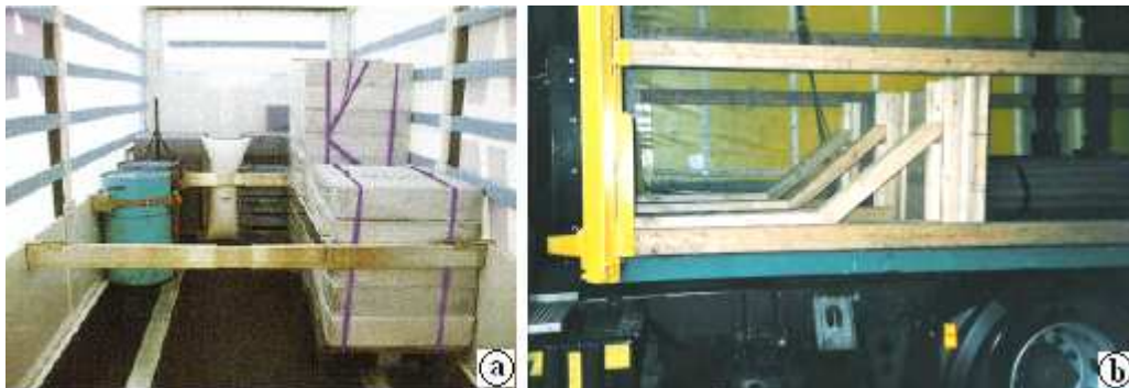
Slika 92: Zadrževalne letve in lesene konstrukcije
