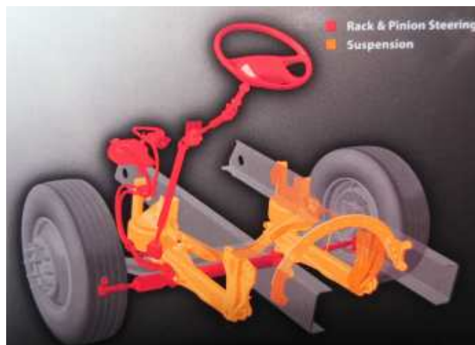
Slika 28: Spremenjena – nekonvencionalna konstrukcija vpetja osi v podvozje
