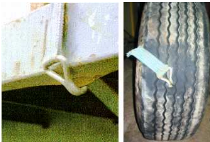
Slika 58: Pritrdjevanje pasu za rob nadgradnje in možne posledice
