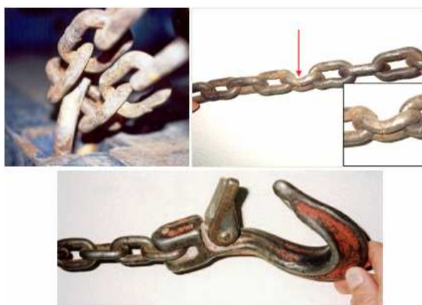
Slika 83: napake pri pritrjevanju tovora z verigami ter poškodbe verig
