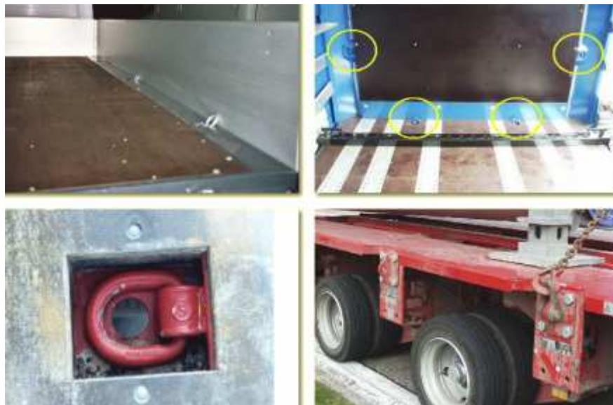
Slika 56: Mesta za pritrdjevanje na nadgradnjah tovornih vozil
