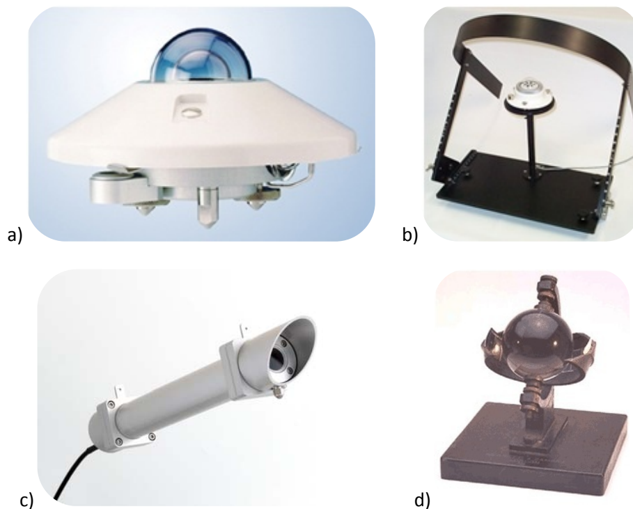
Slika 4.25: Inštrumenti za merjenje sončnega sevanja; a) piranometer, b) piranometer s senčilnim obročem, c) pirheliometer in d) Campbell-Stokecov heliograf.
