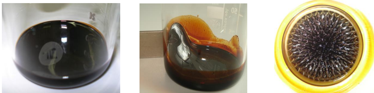
Slika 2.4: Magnetna tekočina in vpliv magnetnega polja trajnega magneta.
