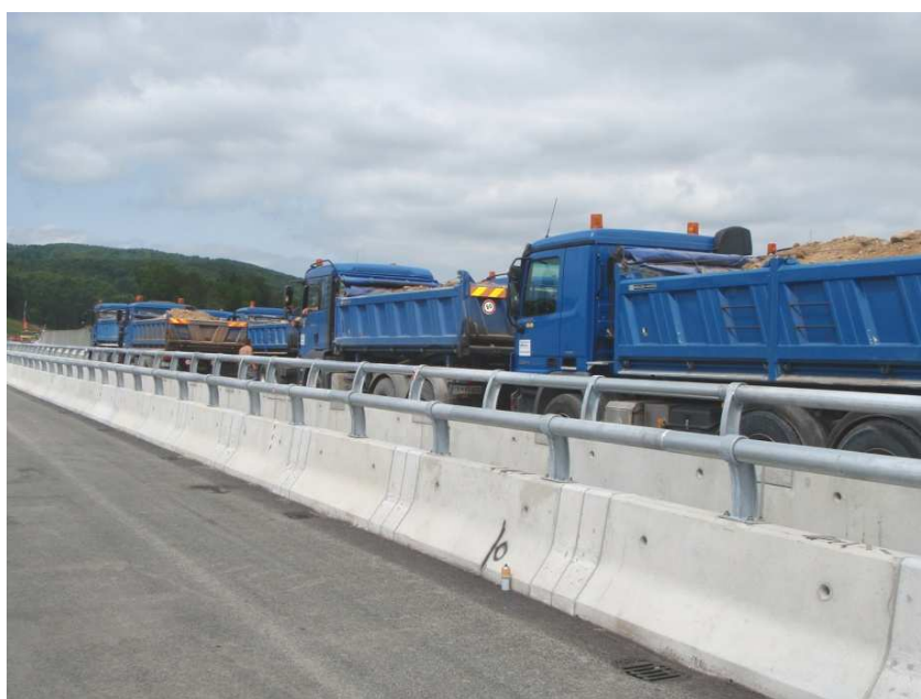
Slika 4.2: Primer obremenjevanja sosednjih polj levega objekta
