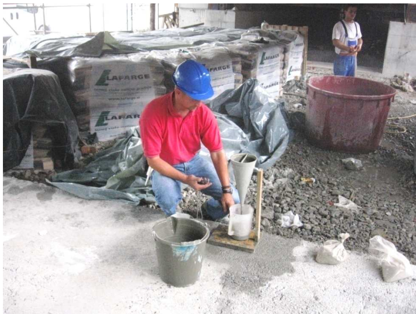
Slika 3.16: Kontrola pretočnosti injekcijske mase
