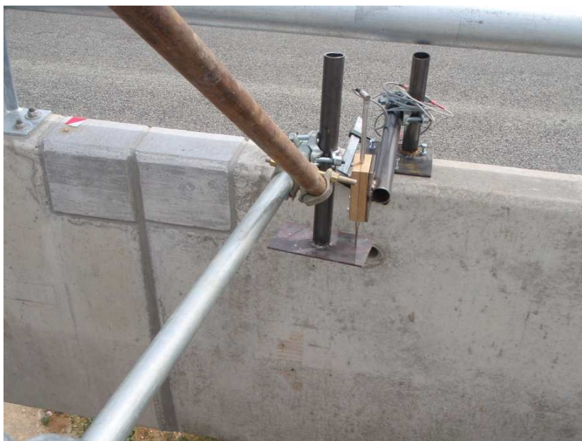
Slika 4.6: Induktivni merilec pomikov nameščen na krajši konzoli pritrjeni na BVO desnega objekta in se dotika konzole, ki sega z levega objekta (sredina 4. polja – mersko mesto IND-02)
