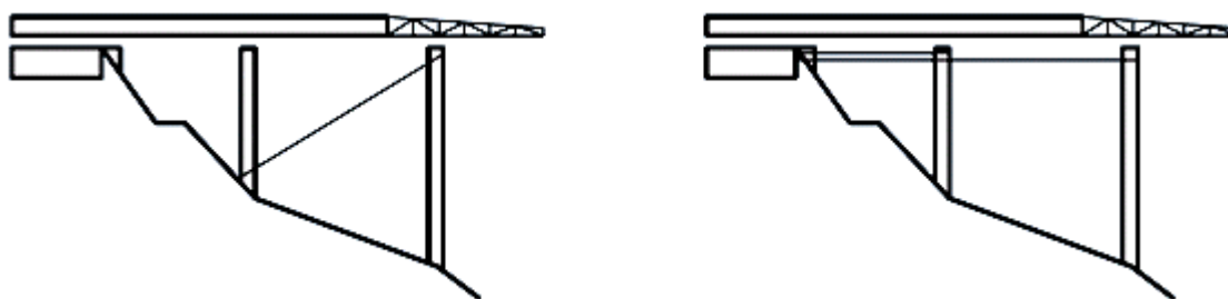
Slika 2.22: Pridrževanje stebrov med narivanjem
