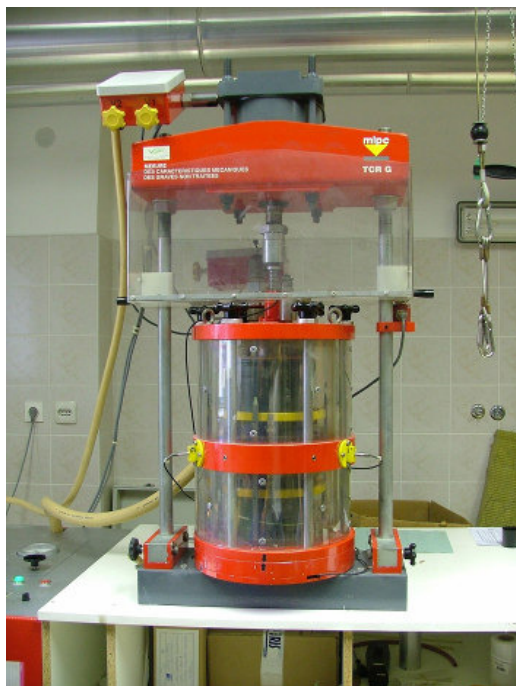
Slika 5.9: Ciklični triosni aparat na Zavodu za gradbeništvo Slovenije
