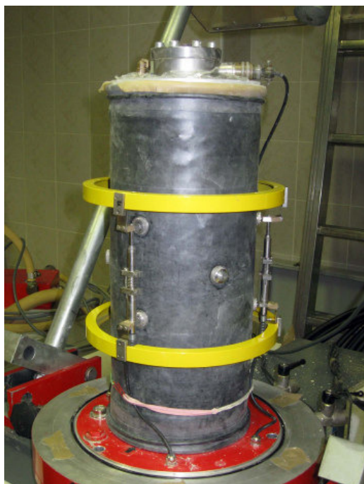
Slika 5.10: Preizkušavec za ciklične triosne preiskave z nameščenimi lokalnimi merilci vertikalnih deformacij
