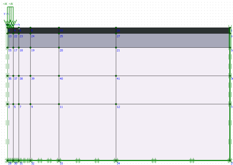
Slika 4.7: Sestava triplastne voziščne konstrukcije
