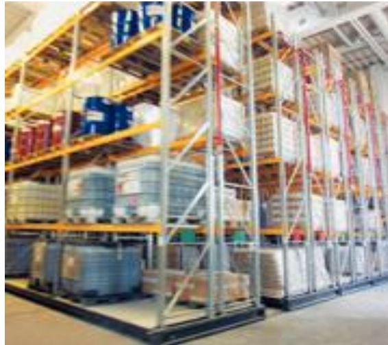
Slika 5: Primer premakljivih regalov (Vir: www.jungheinrich.si ).
