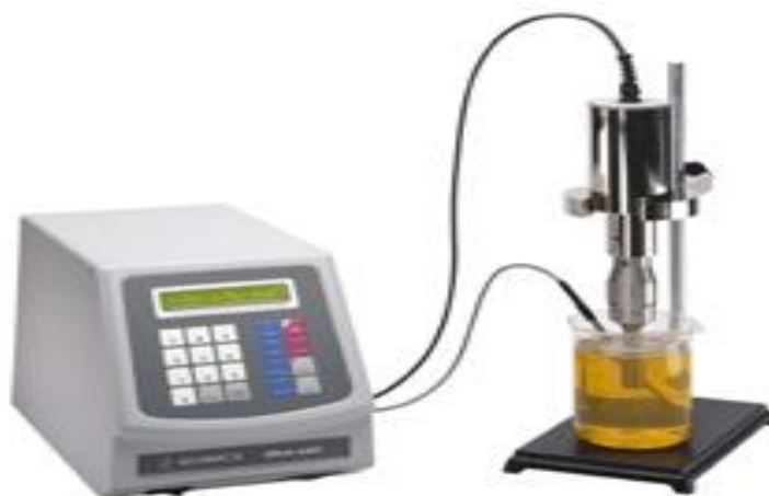
Slika 1.3: Ultrazvok za sonokemijsko metodo [10]
