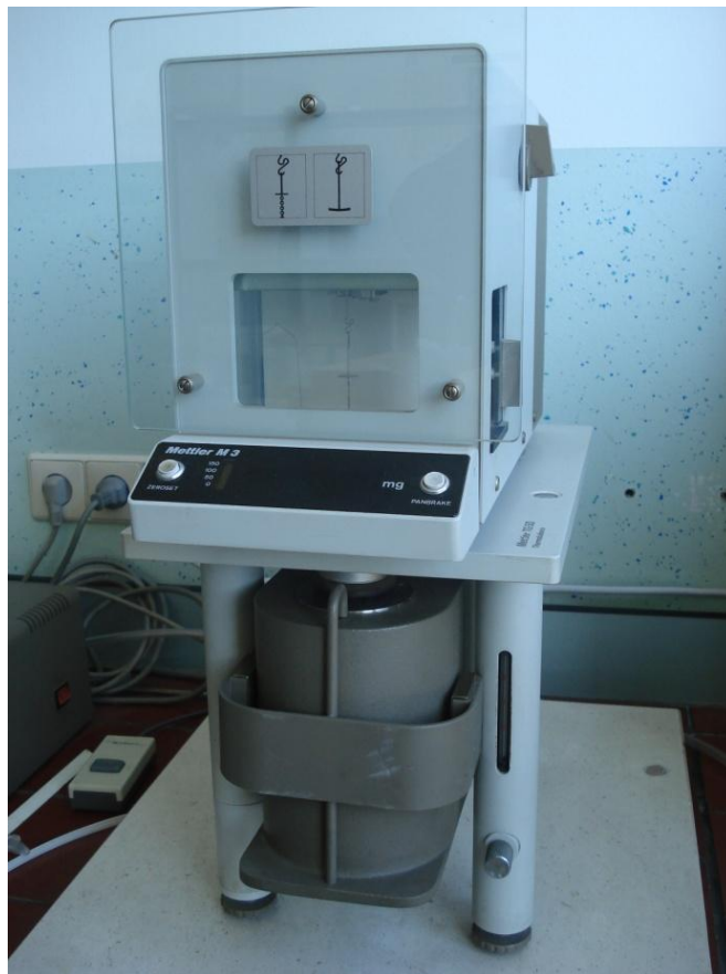
Slika 2.1: TG 50 Mettler Toledo, na katerega je pritrjen magnet
