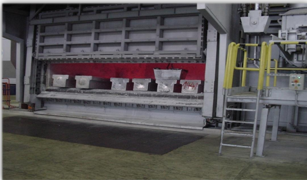
Slika 1.2: Plinska dvokomorna talilna peč z vstavljenimi aluminijastimi bloki
