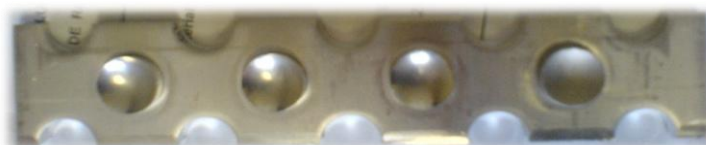
Slika 3.3: Vzorec traku z rondicami premera 19,7 mm
