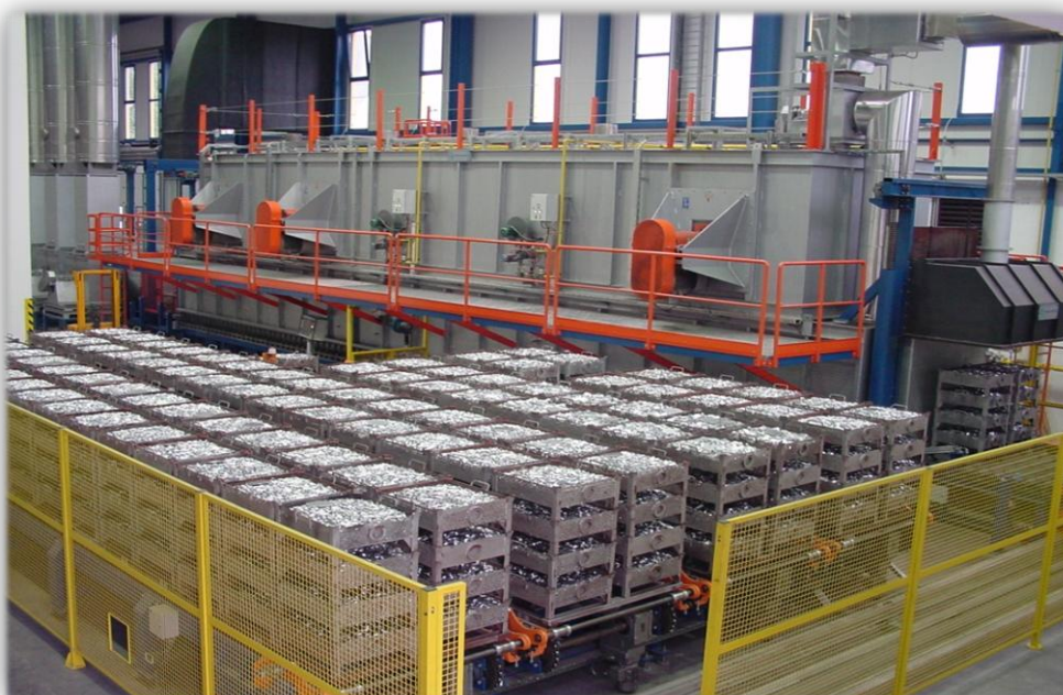
Slika 1.4: Žarilni vozovi s paletami rondelic (spredaj) pred veliko žarilno pečjo (zadaj) (Talum, d. d)
