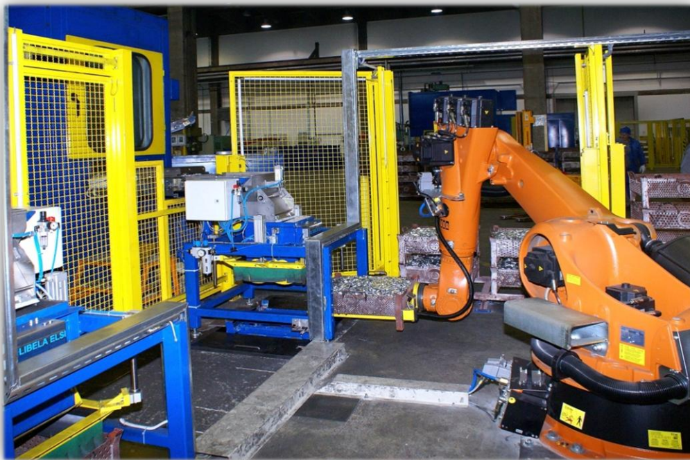
Slika 1.3: Za izsekovalnim strojem (levo) se rondelice zbirajo v žarilnih posodah, ki so s pomočjo robota naložene na žarilne palete (desno) (Talum, d. d)
