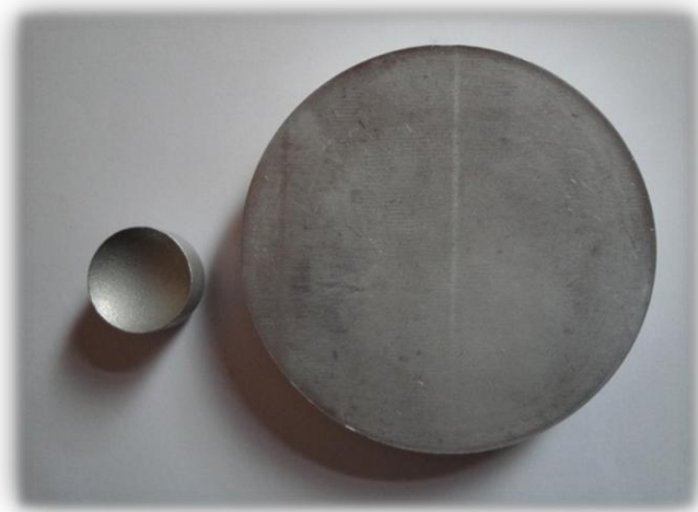
Slika 1.5: Vbočena rondica (welb) (levo) in rondica z ravnim dnom (desno) po površinski obdelavi
