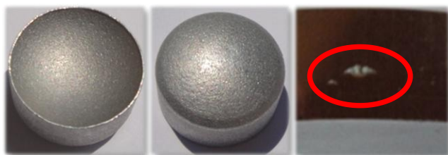
Slika 1.6: Rondica D = 19,7 mm z napako na robu
