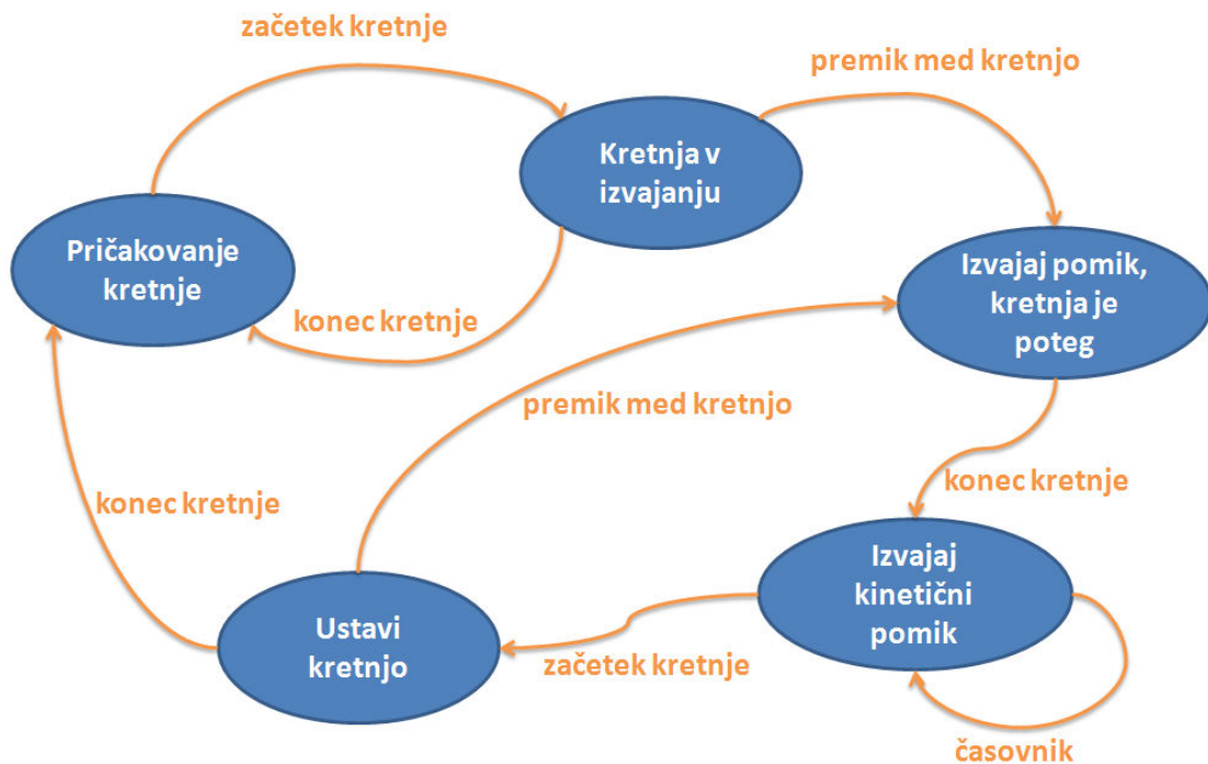
Slika 4.16: Visokonivojski diagram stanj pri izvajanju kinetičnega pomika ob sunku.
