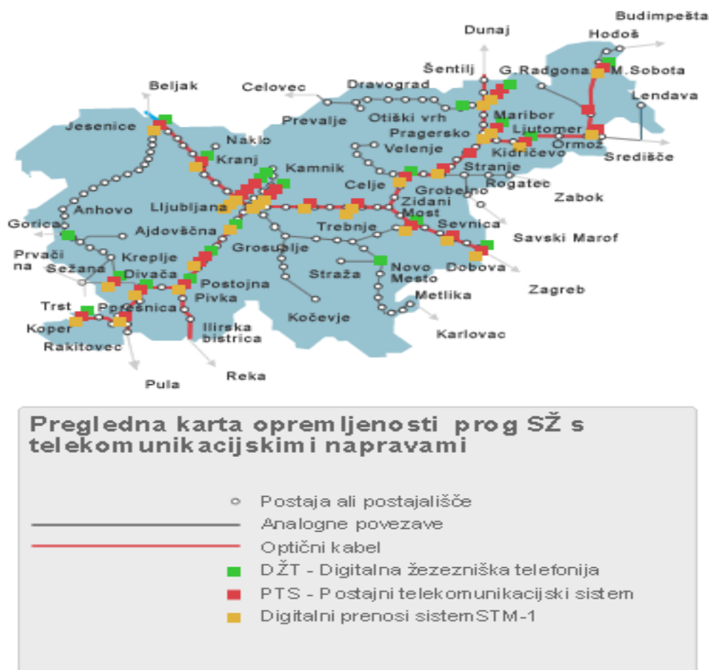
Slika 8: Telekomunikacijska mreža Slovenskih Železnic
