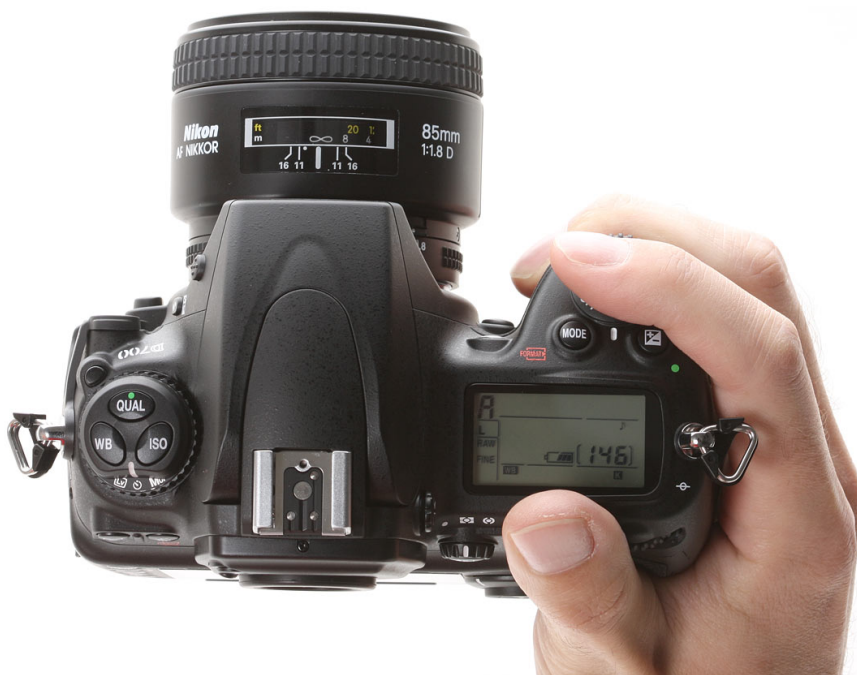
Slika 5.24: Napačna pozicija sprožilca na telesu fotoaparata.
