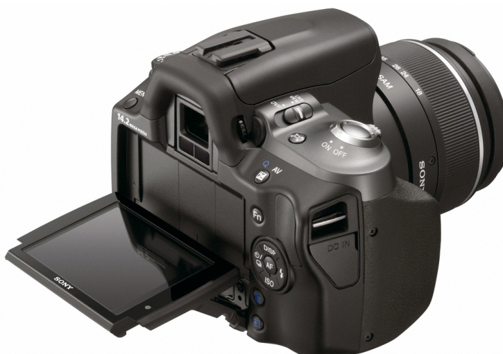
Slika 5.36: Nagibni mehanizem LCD zaslona.
