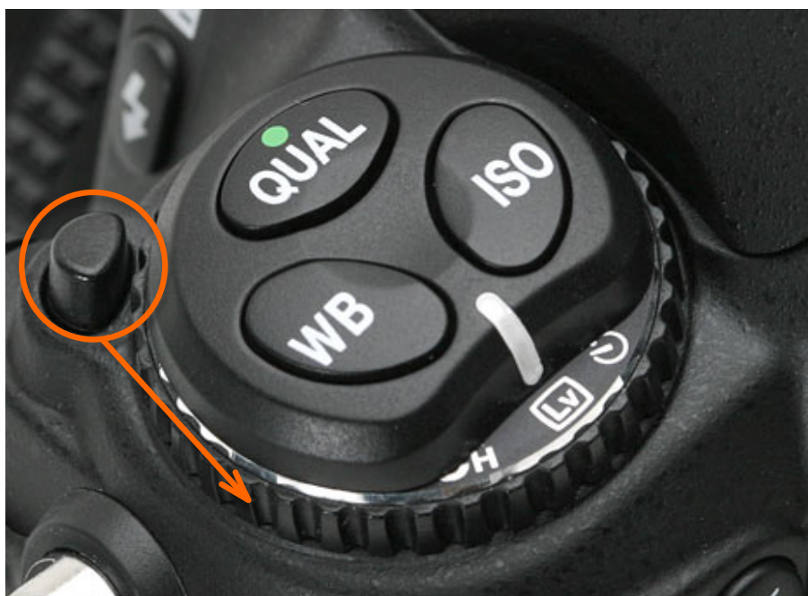
Slika 5.28: Vrtljivi gumb z zaklepom na fotoaparatu.
