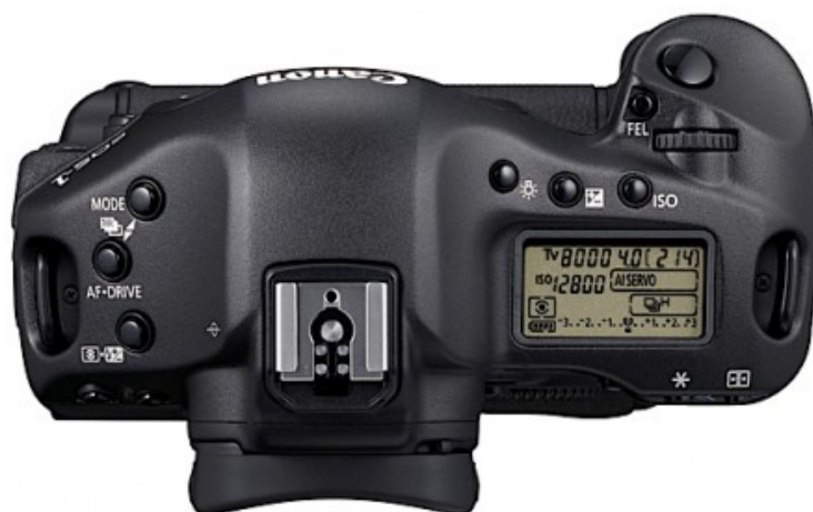
Slika 5.38: Monokromatski LCD zaslon za pregled nad nastavitvami in podatki.
