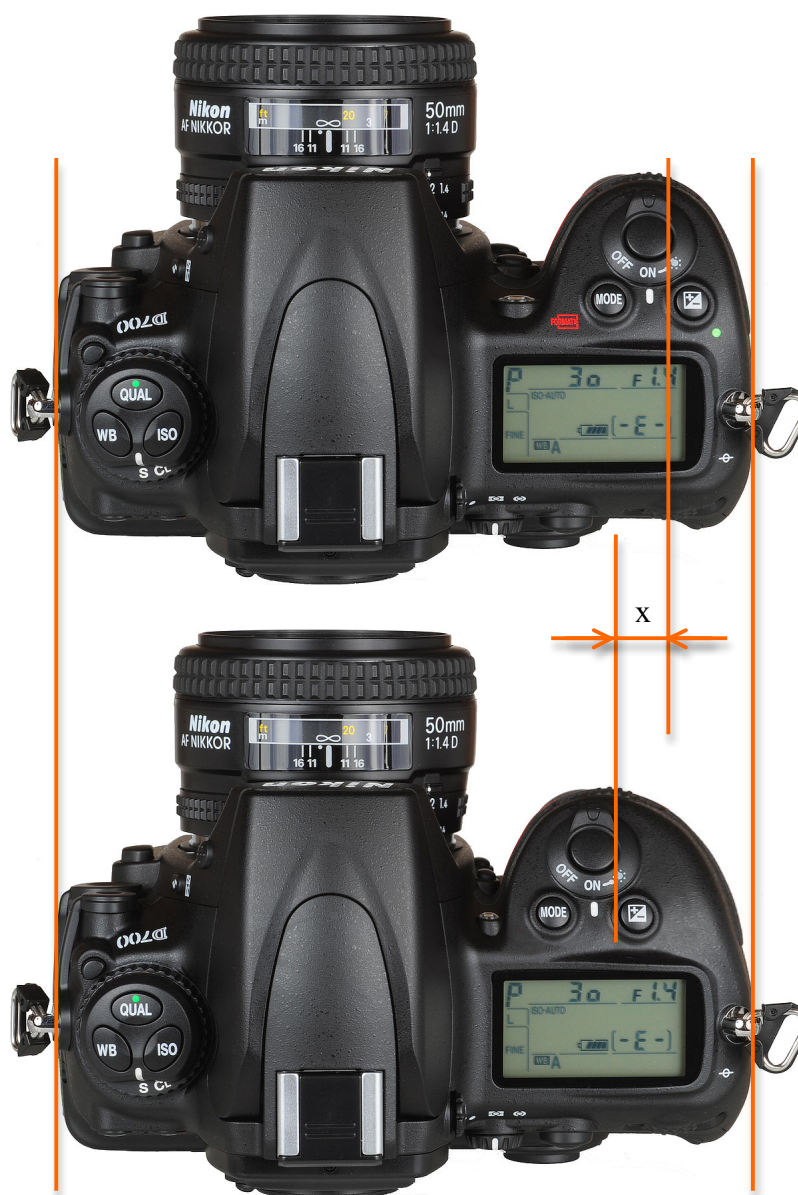
Slika 5.25: Rešitev problema naleganja kazalca na sprožilec.
