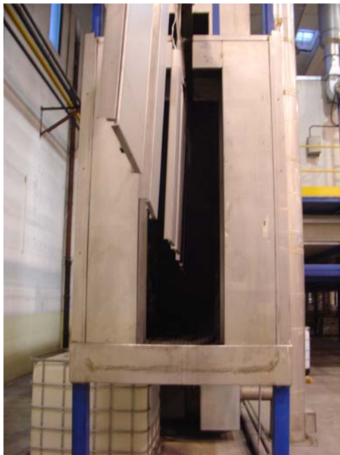
Slika 24: Pranje z visokotlačnim čistilcem
