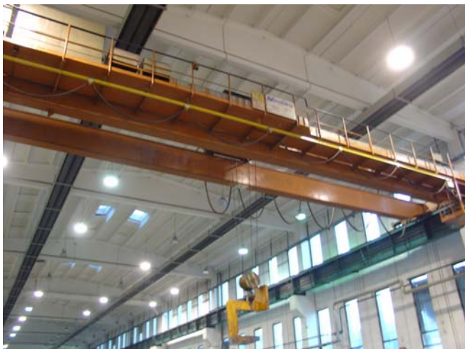
Slika 13: Žerjav, ki namešča kolut na proizvodno linijo za police ali hrbtišča
