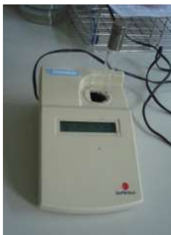
Slika 5.6: McF aparat za merjenje motnosti
