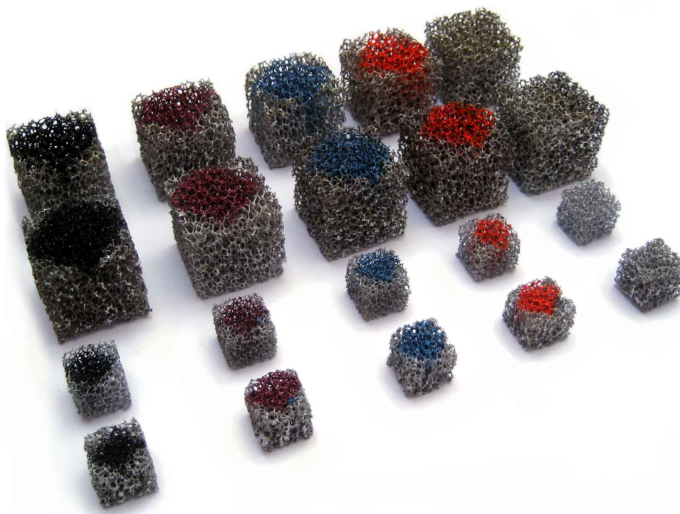
Slika 3.1: Vzorci aluminijeve odprto-celične pene proizvajalca m-pore v obliki kock velikosti 40 × 40 × 40 mm z velikostjo celic 10 ppi in v velikosti kock 20 × 20 × 20 mm z velikostjo celic 20 ppi
