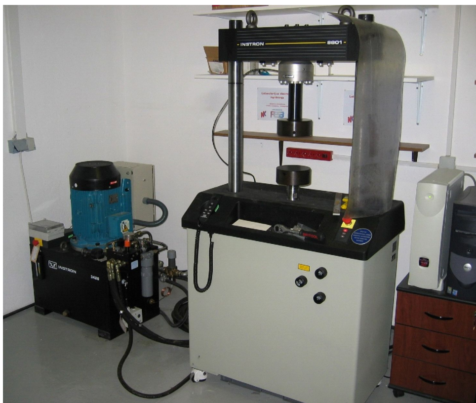
Slika 5.1: Računalniško voden servo-hidravlični stroj INSTRON 8801
