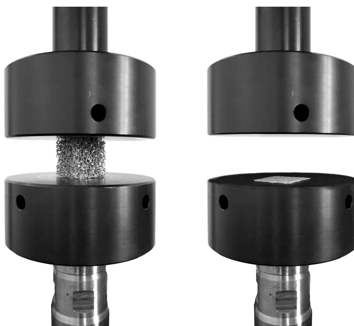
Slika 5.2: Položaj preizkušancev glede na zgornjo oporno in spodnjo delovno glavo pred preizkušanjem (levo) in po preizkušanju (desno)
