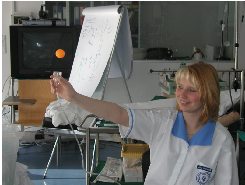
Slika 2.12: Levitacija žogice med simulacijo delovanja inhalatorja.
