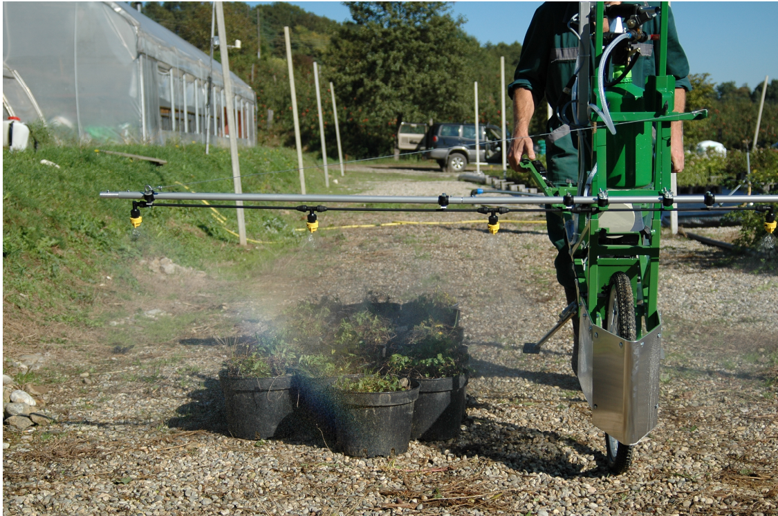
Slika 4: Metoda aplikacije glifosata na rastline njivskega slaka ( Convolvulus arvensis L.) z uporabo eksperimentalnega pršilnika Technoma Euro-Pulve (Kolmanič, 2006)
