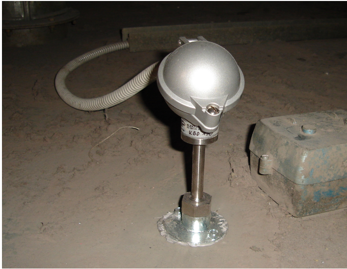
Slika 3.5: Temperaturna sonda PT-100 za merjenje temperature
