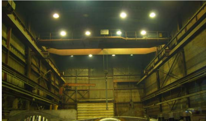
Slika 32: Žerjavna proga z mostnim dvigalom
