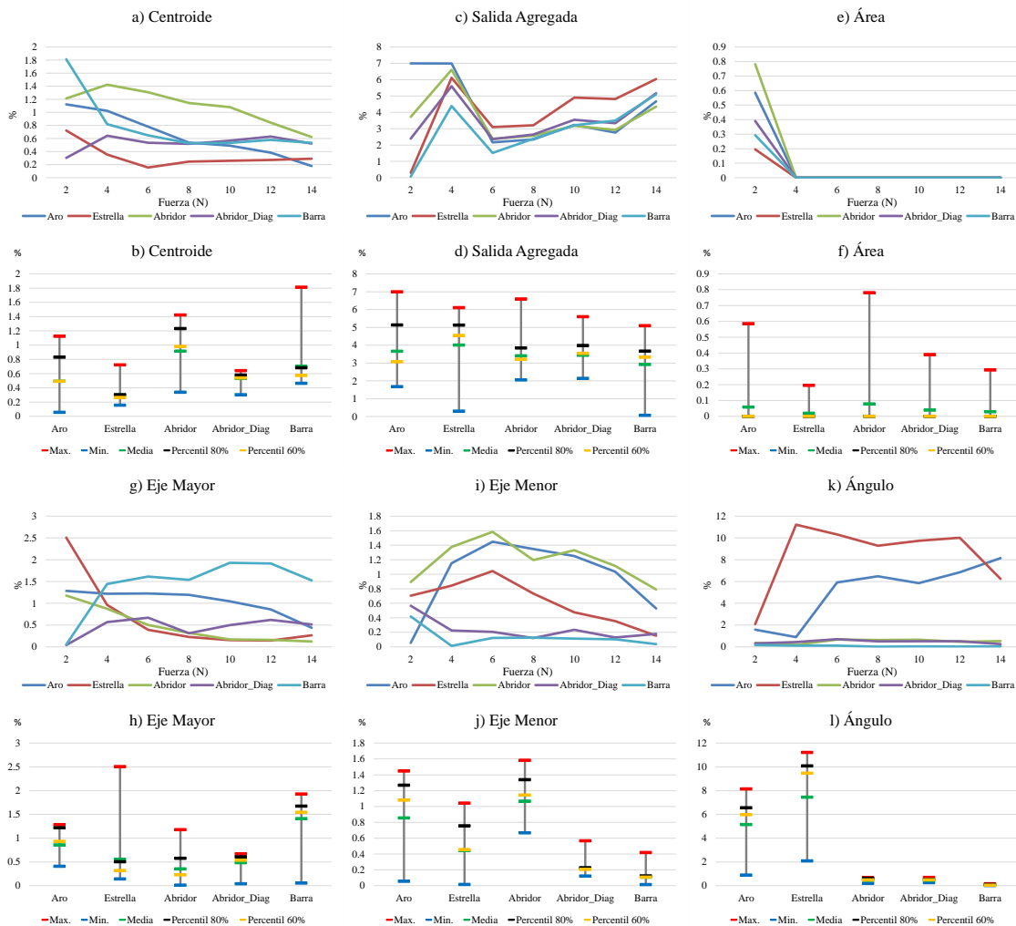
Figura 3-11. Variaciones de los parámetros provocadas por el error de dispersión en el sensor de Tekscan.
