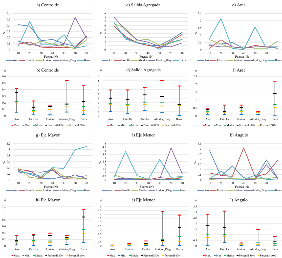
Figura 3-10. Variaciones de los parámetros provocados por la deriva del sensor de Tekscan.
