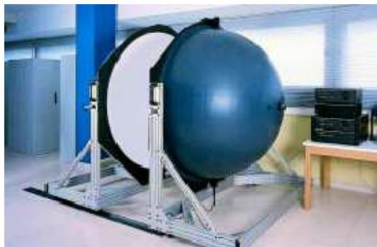
**Figura 31 Esfera de Ulbricht (Fuente Indalux)**
