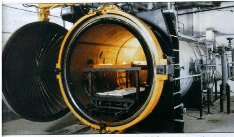
El conjunto se introduce en el autoclave para la realización del ciclo de curado (2-14 bares)
