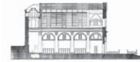
Nueva cubierta y sección longitudinal del proyecto.
