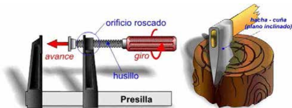
Figura 5.7: Plano inclinado como husillo (izq.) y como cuña (hacha de la der.) (Fuente: © CEJAROSU)
