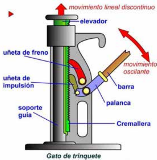
Figura 5.106: Gato de trinquete. Transforma el movimiento oscilante en lineal discontinuo. (Fuente: © CEJAROSU)
