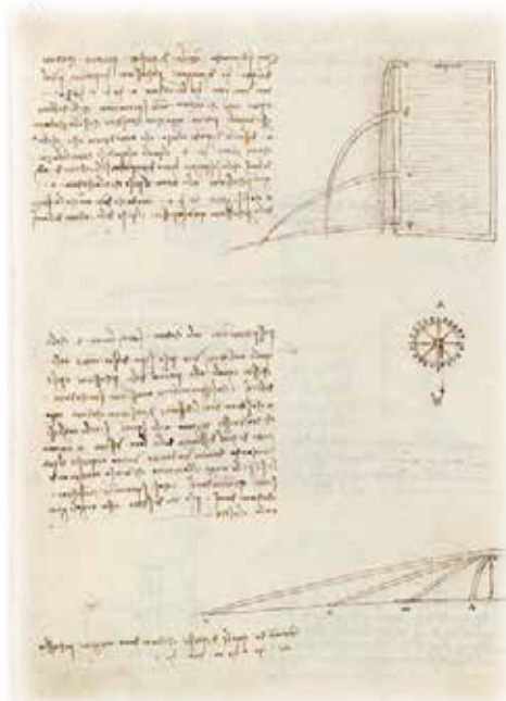
Figura 6.16: Estudio experimental sobre la caída del agua para mover ruedas de molino. Biblioteca Nacional de España (Madrid), Códice de Madrid I, f. 0134v
