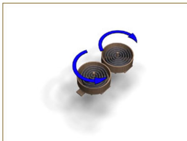
Figura 9.63: Los muelles en espiral, dispuestos bajo el carro, se cargan en direcciones opuestas, tal y como se indican con las flechas azules. Imagen de síntesis. Fuente: web L'Automobile.
