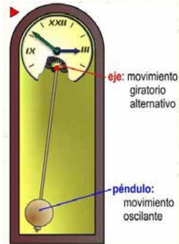
Figura 5.2: Movimiento giratorio alternativo y oscilante del péndulo de un reloj (Fuente: © CEJAROSU)
