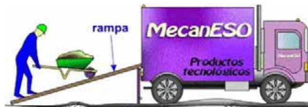
Figura 5.6: Plano inclinado usado como rampa. (Fuente: © CEJAROSU)
