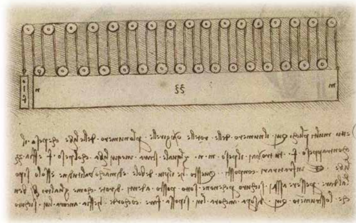
Figura 5.23: Polipasto compuesto por 33 poleas.
