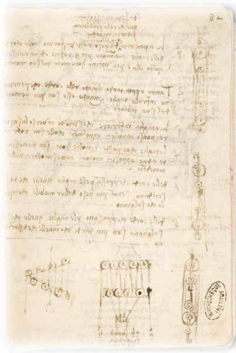
Figura 5.22: Principios mecánicos del funcionamiento de los polipastos. Instituto de Francia (París), Ms. G, f. 0082r
