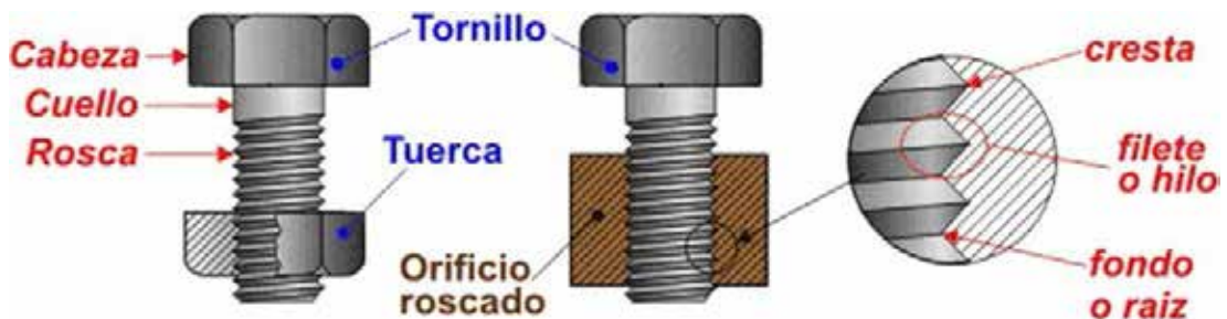
Figura 5.50: Partes de un tornillo (Fuente: © CEJAROSU)
