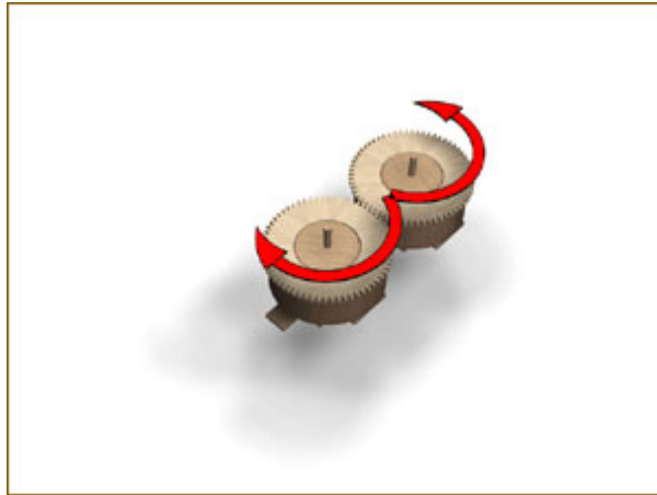
Figura 9.64: La energía liberada por los muelles hace girar las ruedas dentadas en la dirección horizontal indicada por las flechas rojas. Imagen de síntesis. Fuente: web L'Automobile.
