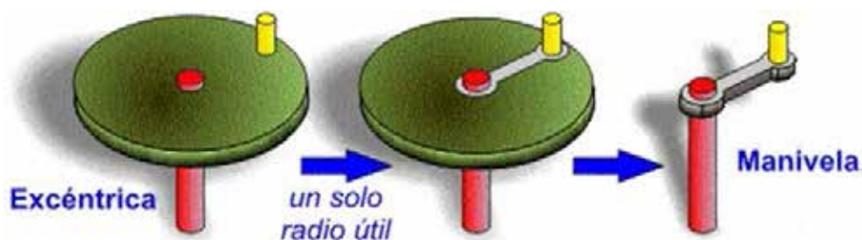
Figura 5.89: De la excéntrica a la manivela. (Fuente: © CEJAROSU)
