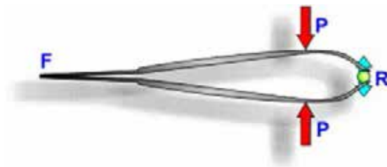
Figura 5.81: Palanca de tercer grado. (Fuente: © CEJAROSU)
