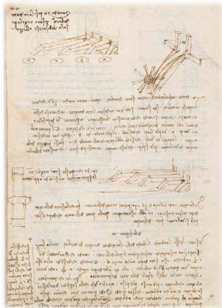
Figura 6.23: Cálculos de los canales que llevan el agua hasta los molinos y la fuerza que realiza para moverlos.
