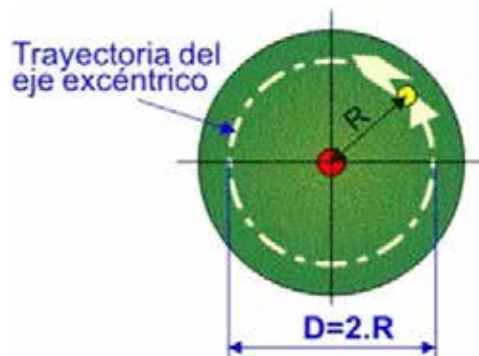
Figura 5.84: Trayectoria del eje excéntrico.
