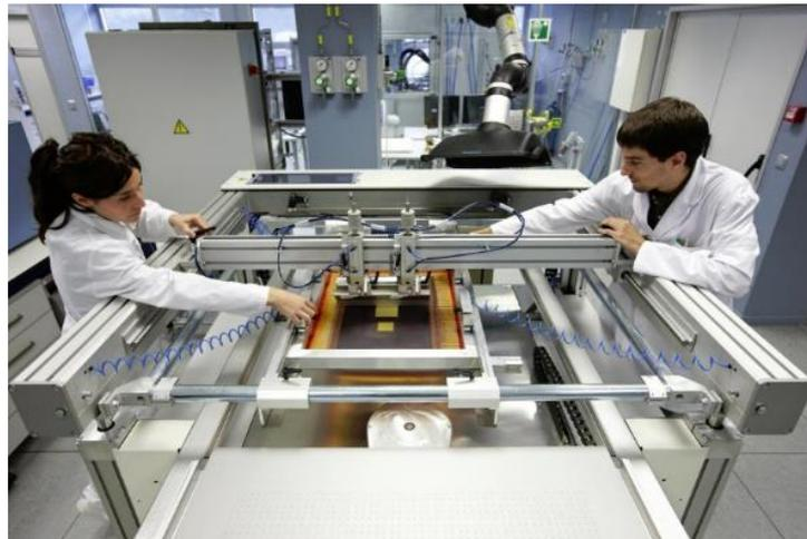
**Figura 3-1.** Máquina semiautomática para serigrafía.
