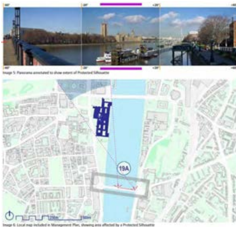
Figura 5.11: Uso de plantas y vistas panorámicas en la ciudad de Londres. En este caso, se identifican los extremos de la silueta a proteger, y el recorrido al que debe afectar esta medida. Con esos datos, se define una superficie de protección tras la silueta (sombreado gris). Fuente: Greater London Authority (2012)
