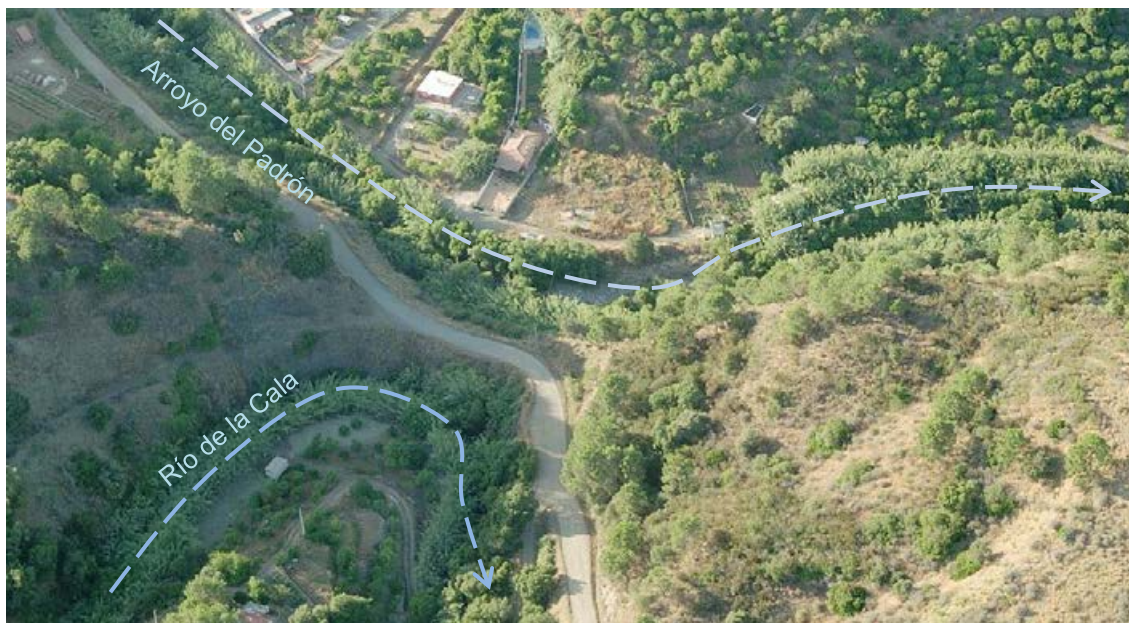
Figura 8. En la imagen se aprecia la zona conocida como “La Pontezuela” (Cuenca de la Cala, Estepona). En este punto, meandros del río de la Cala y del vecino río del Padrón aparecen apenas separados por un estrecho dique natural, que además es usado como camino rural de acceso para las viviendas de la zona. A la peligrosidad natural por un posible desmoronamiento del dique en una crecida de alguno de los ríos, se une la posible inducción por el uso antrópico del mismo, así como la vulnerabilidad generada por los aprovechamientos localizados en el entorno. Foto: Goolzoom.
