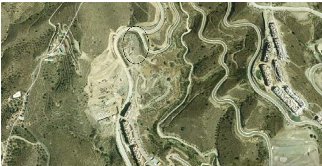
Figura 17. Imagen parcial del tercio septentrional de las cuencas Piletas-Pollo Zamora, en la que se aprecian suelos urbanizados, suelos en proceso de urbanización, zonas con movimientos de tierras e incluso acumulación de depósitos de ésta. Estos depósitos se incorporan a los flujos de escorrentía ya no solo en procesos tormentosos, sino incluso en las lluvias de menor magnitud. Fuente: Google Earth.
