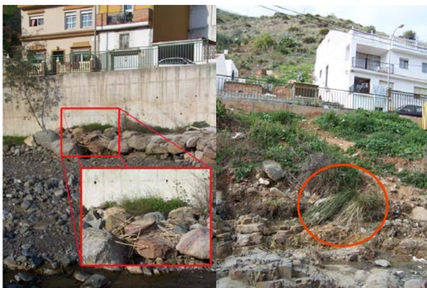
Figura 3. Detalles de restos vegetales que indican la máxima altura alcanzada por el flujo el 6 de noviembre de 2006 en el cauce del arroyo de los Jaboneros. Fuente: Francisco Cantarero Prados.
