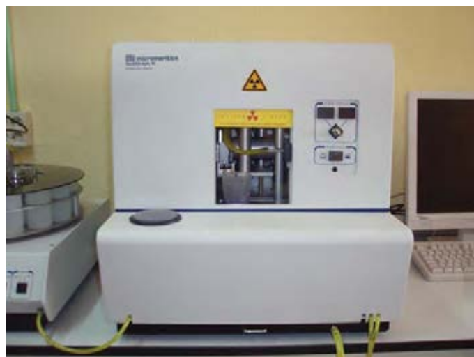
Figura 2.18: Analizador de partículas por rayos-X SediGraph III 5120 ( Micromeritics® ) en el laboratorio del Grupo de Geociencias Marinas.
