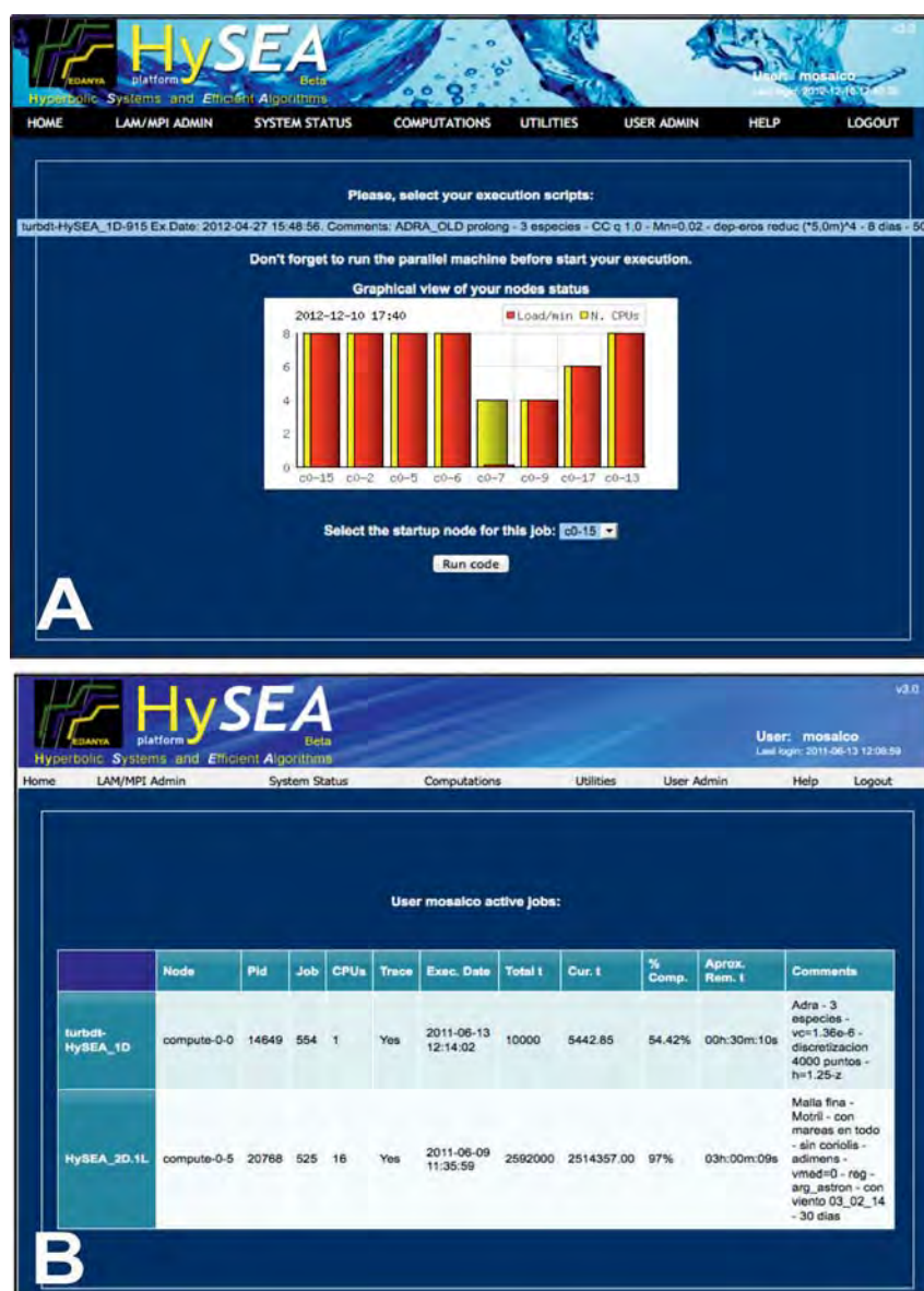
Figura 2.23: Plataforma HySEA . A. Pantalla para la elección del nodo o nodos a los que se envían los cálculos, en ella se muestra el estado de los nodos del clúster que el usuario mosaico tiene a su disposición (en rojo los nodos realizando cálculos) y B. Visualización del estado de los diferentes cálculos lanzados por el usuario mosaico .
