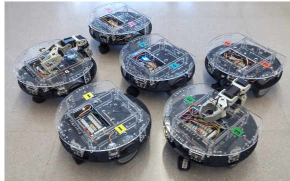
Figura 3: Flota de robots PIERO utilizada para medir el rendimiento de la metodología de Ingeniería Basada en Modelos
