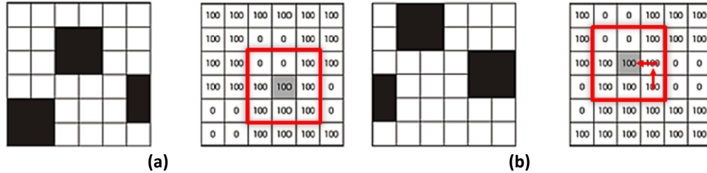
Figura 10. Imágenes y valores de grises (a) referencia (b) deformada [16].
