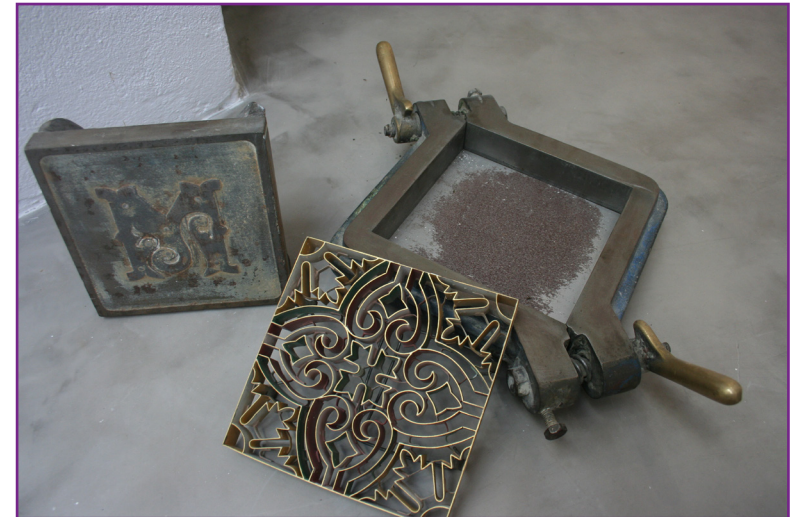
2/ Molde y trepa para fabricación de hidráulicos (Mosaic del Sur)
