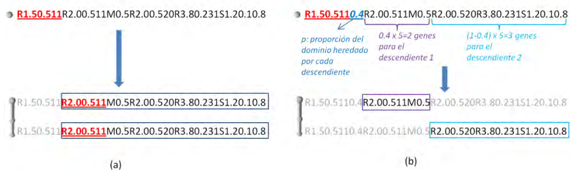
Figura 4.6: Comparación de comportamiento del gen R . (a) la estrategia del modelo original de fomento de simetría bilateral y (b) en la estrategia alternativa de no fomento de simetría.
