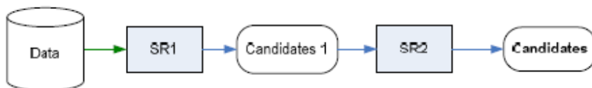
Figura 18. Representación de un SR híbrido por cascada. Fuente: Guzmán (2009)
