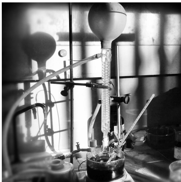
Figura 3.2. Fotografía del reflujo de APTES en tolueno.
